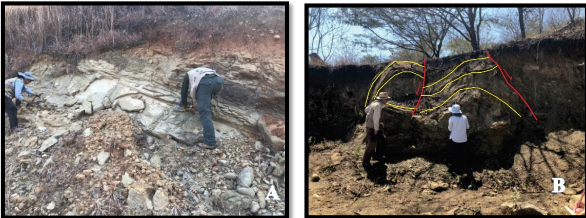
Figura 3.2. (A) Muestreo de rocas para análisis en lámina delgada. (B) Medición de flancos de pliegues para análisis estructural.
