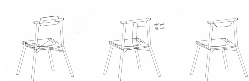
Imagen 137: Exploración de respaldos sobre una sola propuesta de asiento y estructura de madera
