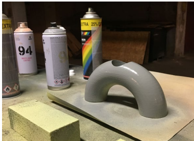
Imagen 97: Pintura de prototipo de una de las propuestas finales de lámpara
