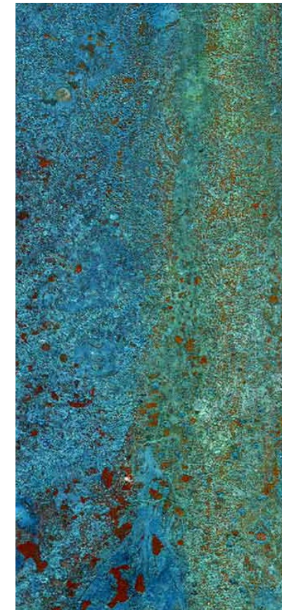
Imagen 60: El acabado patinado es una capa corrosiva que se puede generar sobre una superficie metálica
