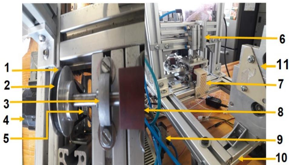
1. Polea GT2 en aleación de aluminio serie 2000 de 60 dientes y 37.6mm de diámetro con barreno de 8mm.
