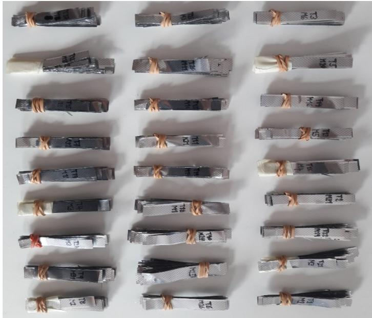
Figura 5.14: Muestras posicionadas ensayo peeling en T
