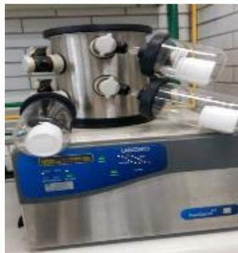
***Figura 16. Liofilización de microcápsulas***
