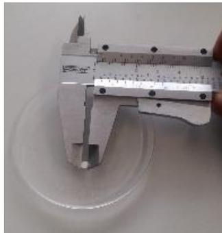
*Figura 14. Medición de microcápsulas con vernier*
