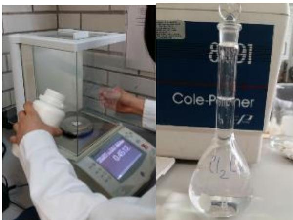
**Figura 5. Preparación de la solución de  $\text{CaCl}_2$  (100mL)**
