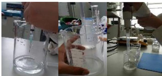
***Figura 8. Extrusión de microcápsulas con jeringa y micropipeta***
