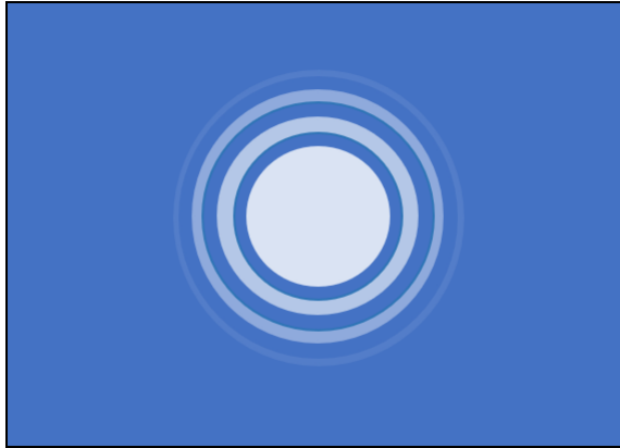
Figura 2.4: Esquema de un patrón de difracción de Fraunhofer circular.
