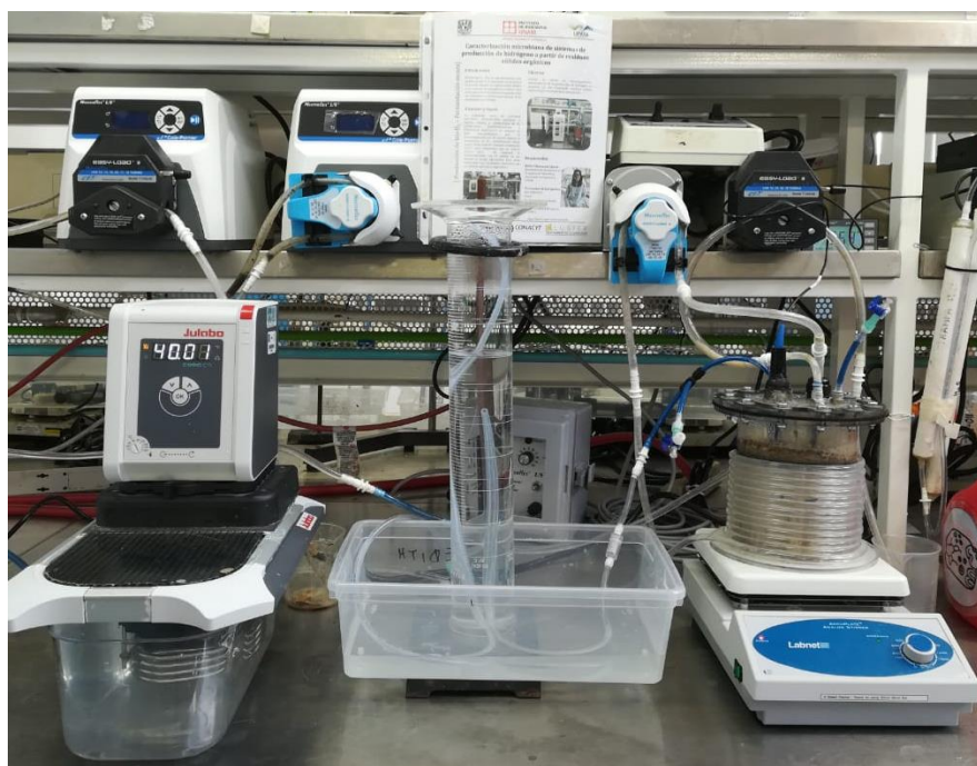
Figura 10. Reactor ASBR para la producción de H_2 .
