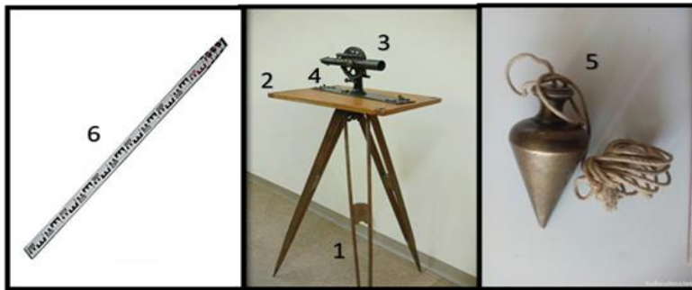
Figura 13. Plancheta y aditamentos: 1) tripié; 2) Plancheta o Restirador de dibujo; 3) Alidada; 4) reglas de escala; 5) Plomada y 6) Estadal (Fotografías del equipo prestado por el Dr. Carlos Garza de la Facultad de Ingeniería).
