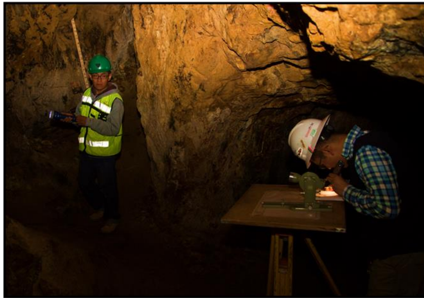
Figura 147. Medición con la plancheta. Foto tomada al interior de la mina Guadalupe durante el trabajo realizado.
