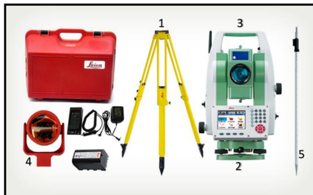
Figura 14. Estación total TS-09 y aditamentos: 1) Trípode; 2) Base niveladora; 3) Estación total; 4) Prisma y 5) Bastón porta-prisma (Leica-geosystems,2019).
