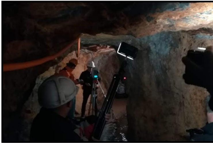
Figura 20. Toma de puntos en interior de mina San Antonio con estación total TS-09, foto tomada durante el levantamiento.
