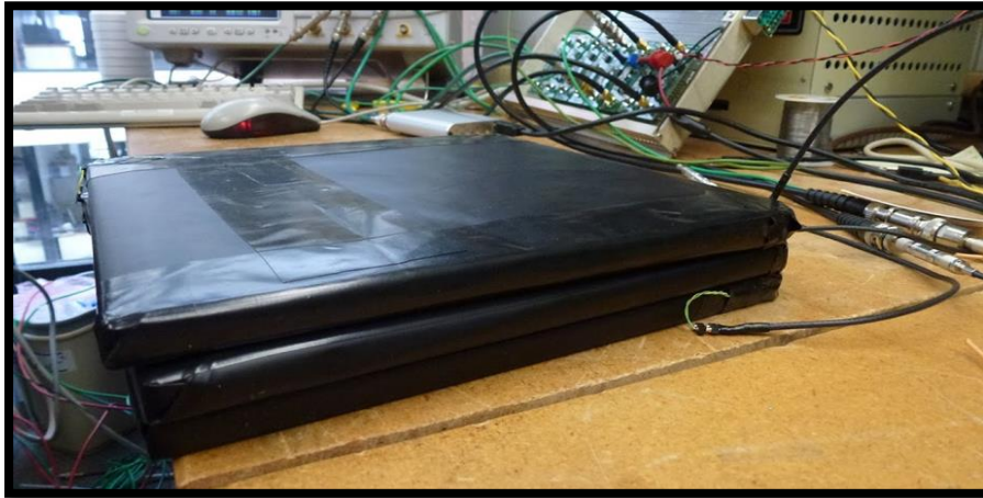
Figura 7. Detector «Escaramujo»: es una pila de centelladores plásticos envueltos en papel tyvek foto del detector armado por Federico Izraelevitch, utilizado a lo largo de la ruta del proyecto Escaramujo (Izraelevitch, 2015).
