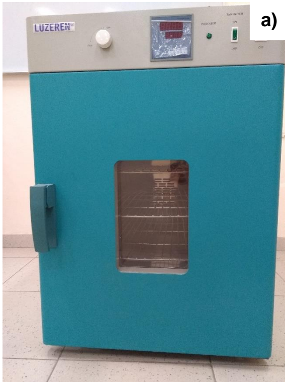
Fotografía. Proceso de secado de tejidos a) Horno en el que se sometieron las muestras a 50°C durante 72 horas, b) tejidos secos después de 72 horas y homogeneizados.
