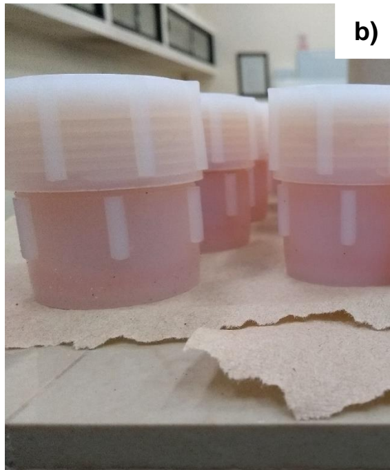
Fotografía. Digestión ácida, a) adición de ácido nítrico ( \text{HNO}_3 ) en campana de extracción, b) muestras después del baño de arena a 120°C.
