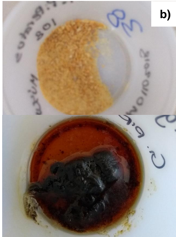
Fotografía. Proceso de secado de tejidos a) Horno en el que se sometieron las muestras a 50°C durante 72 horas, b) tejidos secos después de 72 horas y homogeneizados.
