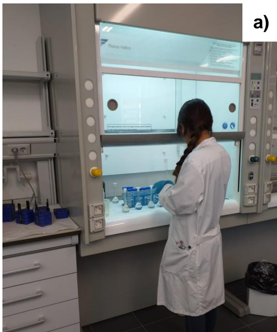
Fotografía. Digestión ácida, a) adición de ácido nítrico ( \text{HNO}_3 ) en campana de extracción, b) muestras después del baño de arena a 120°C.
