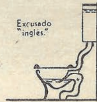
alejamiento de inmundicias por descarga de agua
