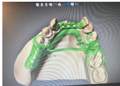
Figura 23: Diseño de los componentes del armazón de PPR en software CAD. Foto proporcionada por el Mtro. Enrique Navarro Bori
