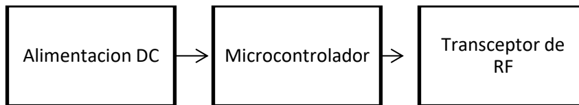
Figura 107 Estructura a nivel hardware del servidor local
