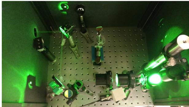
Figura B.3: Salida del Nd:YAG. La luz láser es reflejada abajo por un periscopio para introducirla en el plano de trabajo. Se observan dos polarizadores Glan-Thompson acoplados que sirven como atenuador para reducir la potencia del láser antes de la cavidad del Ti:Zafiro.
