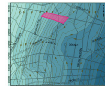
Mapa de contornos de profundidad de depósitos profundos En Tlatelolco: MAXIMA -45 m. MINIMA -37 m.
