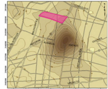
Mapa de contornos del espesor de rellenos superficiales En Tlatelolco: MAXIMA 3.5 m. MINIMA 2.0 m.
