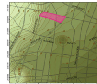
Mapa de contornos de profundidad de la capa dura En Tlatelolco: MAXIMA -31 m. MINIMA -26 m.
