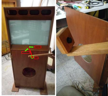
Figura 3.12: Primer prototipo a la izquierda y el final a la derecha
