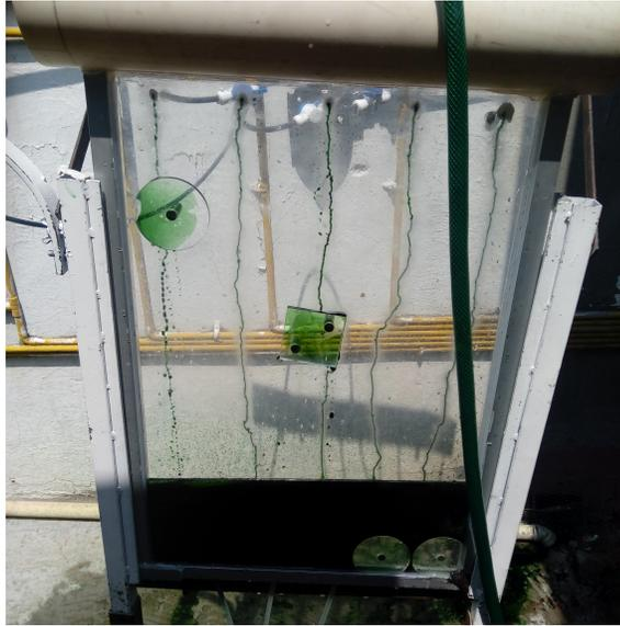
Figura 2.11: Tanque con un círculo y un cuadrado al interior
