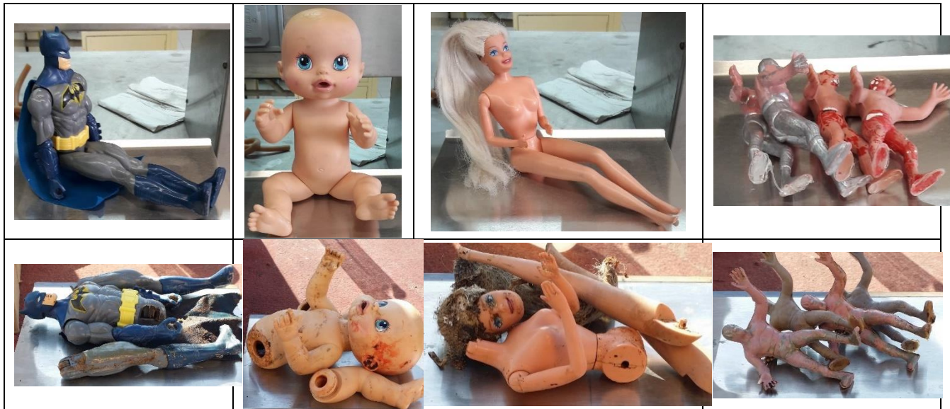
Figura 5.12 Cambios en la coloración de los juguetes en la prueba dentro de los lisímetros
