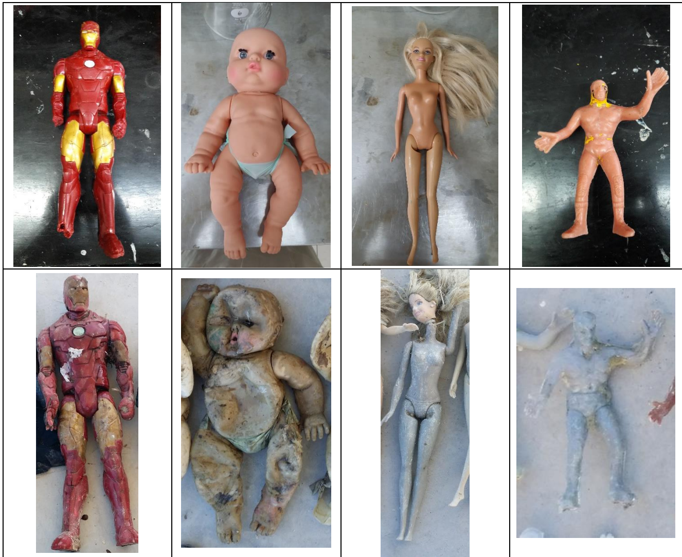
Figura 5.24 Coloración de plásticos antes y después de la prueba en celdas del relleno sanitario
