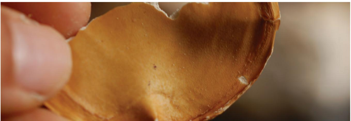
Fig. dy Fotografía de una muestra textil de micelio crecido sobre cultivo líquido, vista inferior.
