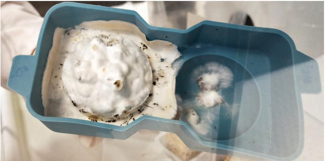
Fig. bn Ejemplo de uno de los moldes utilizado de silicona grado alimenticio con forma de esfera donde crece una muestra de *Ganoderma sp.*
