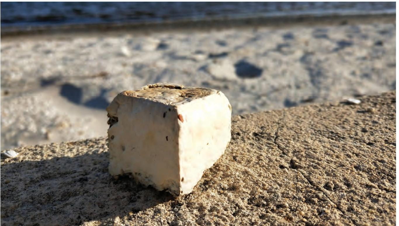
*Fig. eo Imagen de un bloque de micelio de Pleurotus ostreatus en sustrato de eucalipto.*
