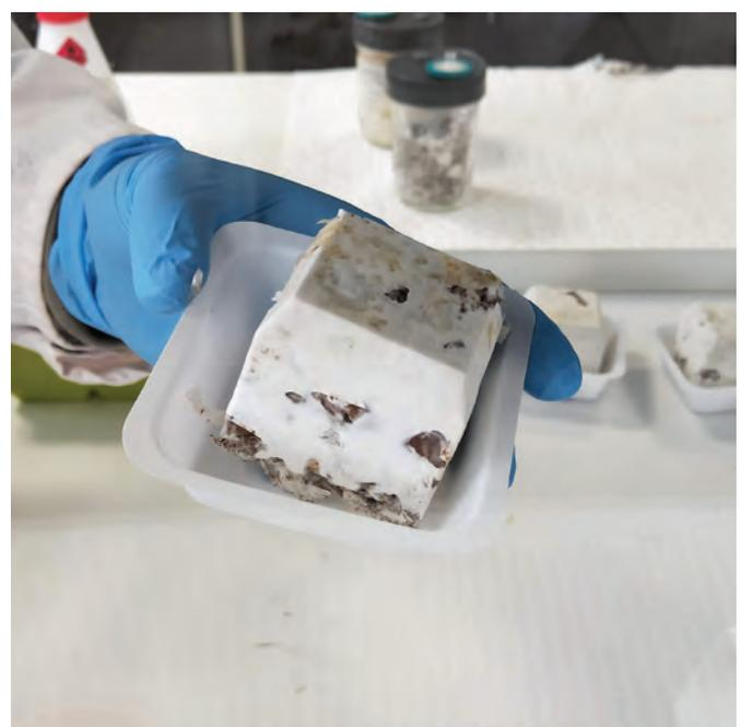
Fig. co Muestra de *Pleurotus ostreatus* crecida en eucalipto tras cinco días de crecimiento dentro del molde de silicón grado alimenticio de pared de 2mm.
