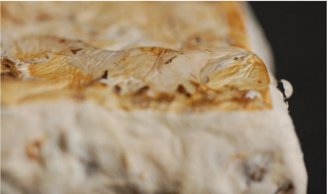
Fig. dn Fotografía con zoom del material resultante Funguy demostrando su capacidad impermeable.
