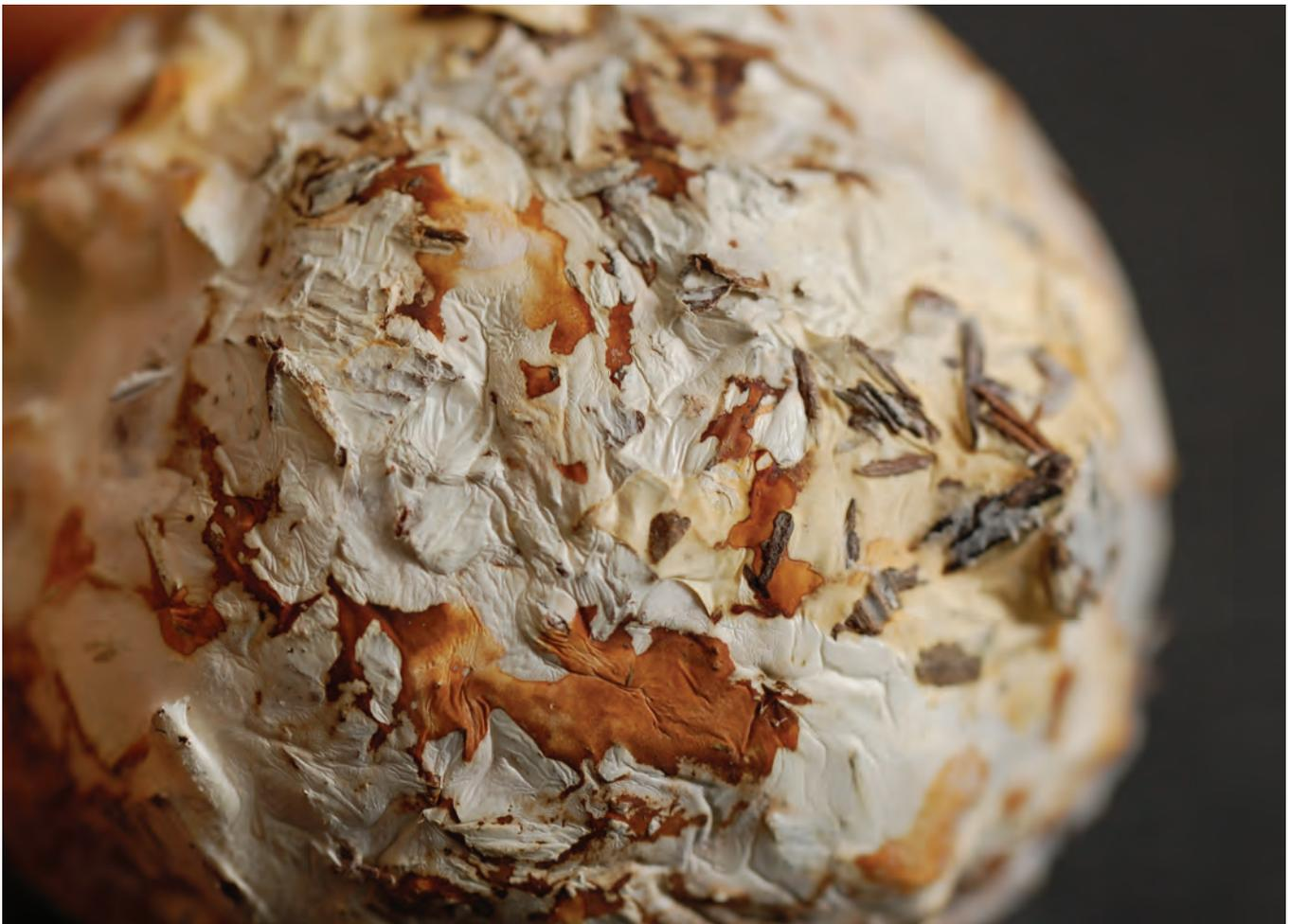
Fig. dp Imagen de acercamiento de Funguy, donde se perciben las partículas de sustrato en café oscuro a la derecha, en blanco el micelio de *Ganoderma steyaertnum* y en café claro micelio tostado resultado de la deshidratación en el horno.
