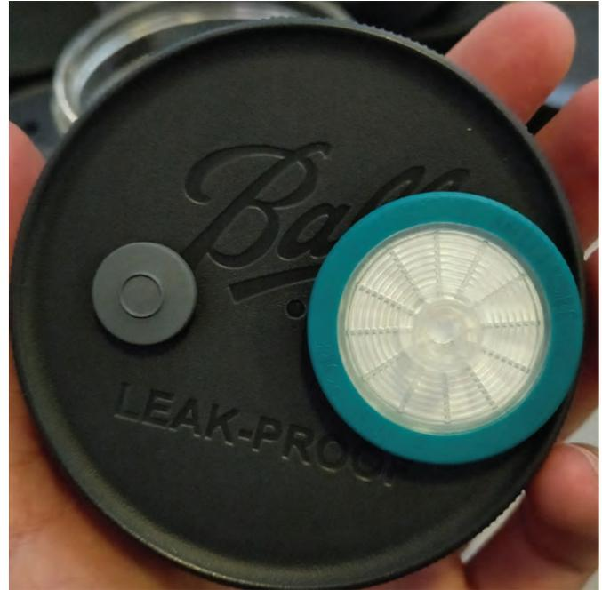
Fig. bq Ejemplo de una tapa para líquido de cultivo con el filtro de jeringa de 22 micras y el sello autoreparable de silicona.
