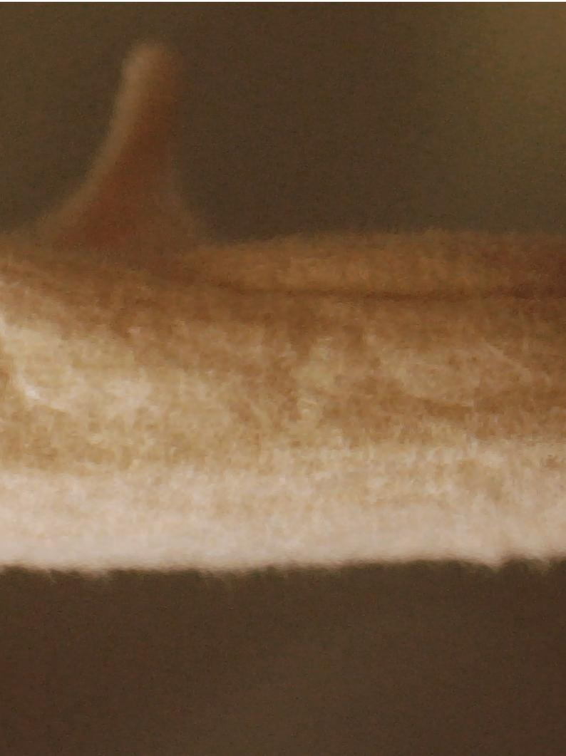
Es posible sintetizar un bio-material transformable industrialmente que surge a partir de la interacción de un hongo (micelio *Pleurotus ostreatus* en dos variedades y *Ganoderma sp*) y un sustrato (compuesto de lignina que proviene de desechos vegetales) resultando en un bio-compuesto que es capaz de aplicarse en soluciones de diseño (servicio, sistema, producto) dadas sus características físicas, químicas y mecánicas, ofreciendo una alternativa de uso a una necesidad específica.
