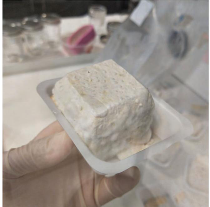
Fig. cq Misma muestra que en la imagen de la izquierda, dos días después de dejarse crecer fuera del molde. Vemos como ese crecimiento extra, invade las paredes exteriores por completo, dando un acabado uniforme en el contorno del material.
