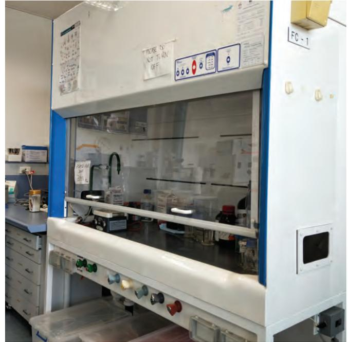
Fig. bo Ejemplo de una cabina de seguridad grado 2 dentro de los laboratorios de UWA.
