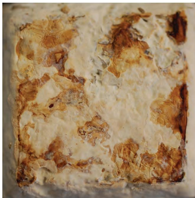
Fig. ct Fotografía de una muestra final crecida en forma de cubo, ejemplificando el tipo de acabados que se pueden obtener tras la cocción para frenar el crecimiento del hongo.
