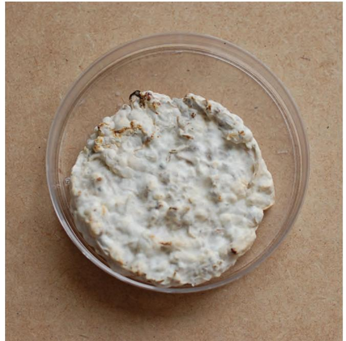
Fig. bz Muestra de micelio de *Pleurotus ostreatus* en sustrato de amaranto mostrando reducción del 30% tras la deshidratación.
