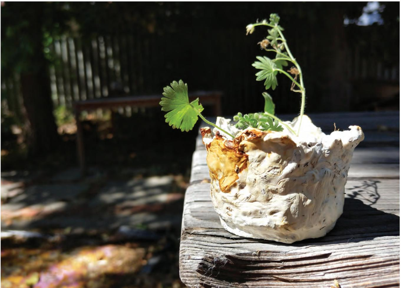
*Fig. dq Imagen de una maceta en donde se sembró una pequeña planta para hacer prueba de la impermeabilidad del material. Duró 1 mes y no presentó ningún tipo de descomposición interna resultado de la humedad de la planta.*
