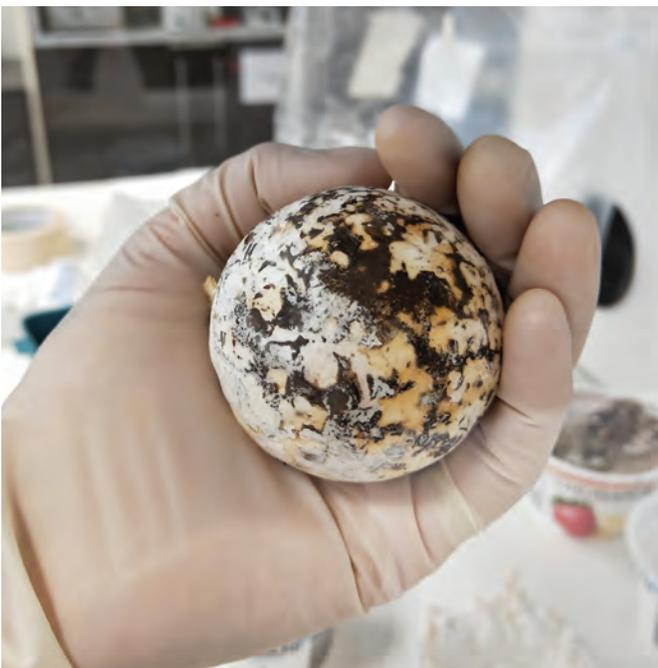
Fig. cr Muestra de cinco días crecida de *Ganoderma steyaertnum* y corteza de eucalipto en molde esférico.
