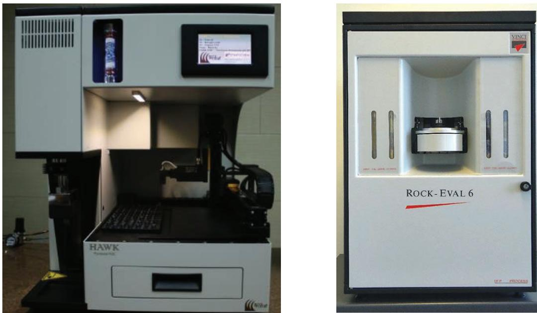
Figura. 4.7. Equipo utilizado para los estudios de COT. *rock-eval* LECO C744 y *rock-eval*™ 6.
