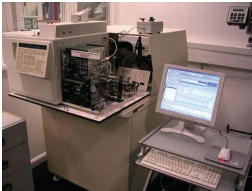
Figura. 4.10. Espectrómetro de masas de flujo Finnigan MAT Delta–S.
