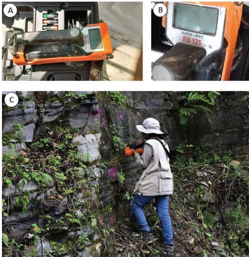
Figura. 4.3. Imágenes relacionadas al levantamiento de Rayos Gamma: A y B) Escintilómetro portátil RS-125; C) medición con equipo en campo.
