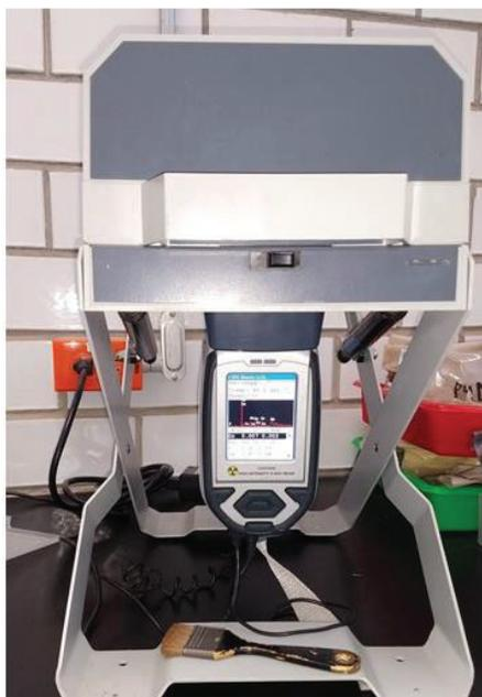
Figura. 4.8. Equipo portátil de Fluorescencia de Rayos X, Thermo Scientific Niton XL3t.
