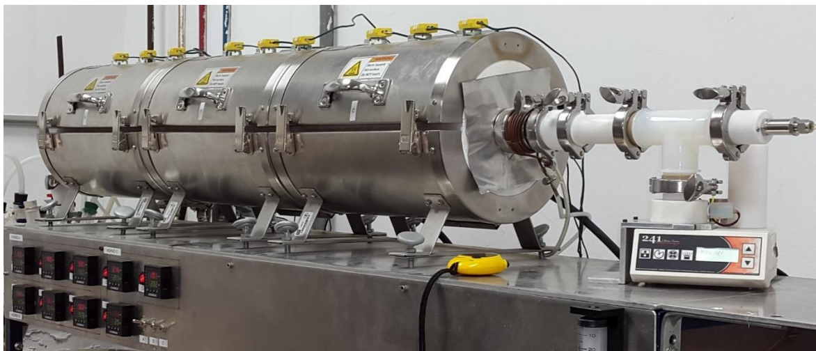
Figura 38. Equipo de síntesis de nanocápsulas y nanoreactores equipado con un atomizador Sonaer de 2.4 MHz y un reactor con 9 diferentes zonas de calentamiento.
