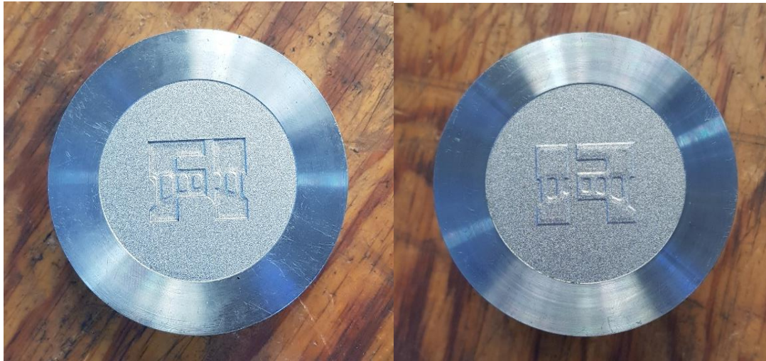
Figura 3.12 Piezas finales, punzón y matriz de estampado obtenidos por el proceso de electroerosión.
