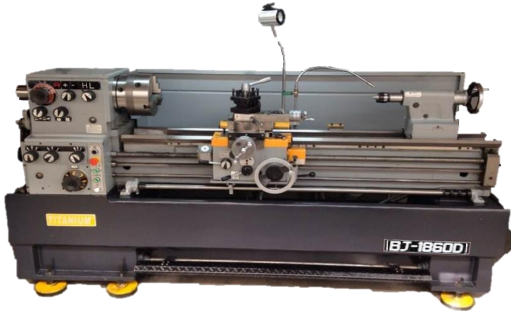
Figura 3.7 Torno convencional Titanium BJ-1860D instalado en el edificio “O” de la Facultad de Ingeniería.
