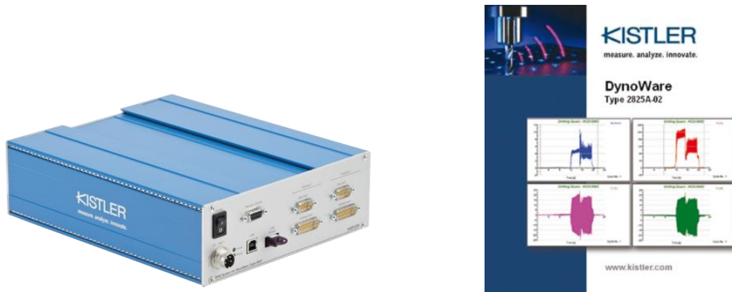
Figura 4.8 Tarjeta de Adquisición de Datos KISTLER 5697 y software DynoWare. [25]
