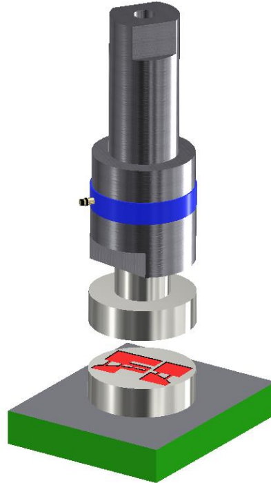
Figura 3.2 Ensamble completo del troquel de estampado junto con el instrumento de medición.
