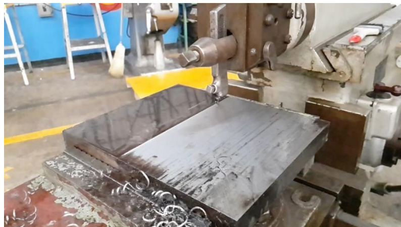
Figura 3.13 Placa portamatriz montada con la ayuda de una prensa en la cepilladora instalada en el edificio "O" de la Facultad de Ingeniería.
