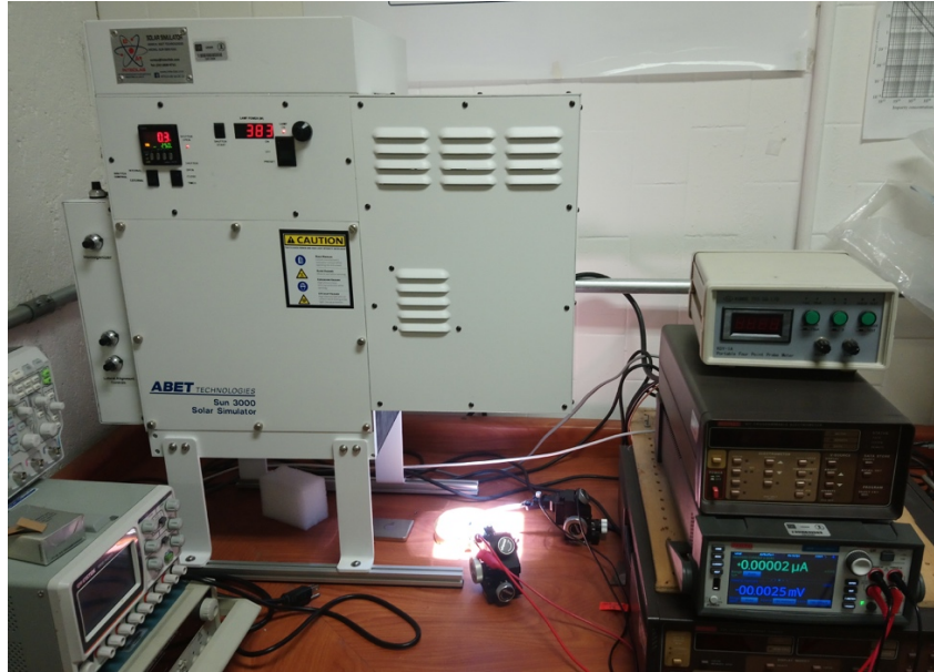
Figura 15.- Arreglo experimental para medir la conductividad en oscuro y bajo iluminación.
