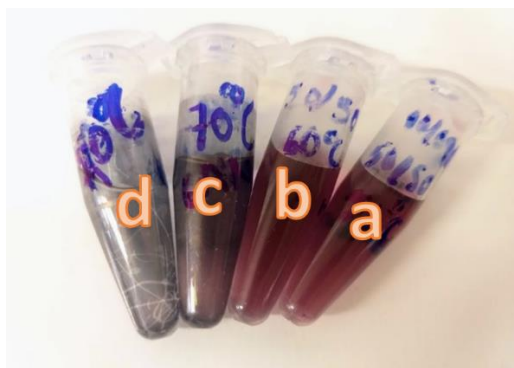
Figura 49. Dispersiones coloidales de AuNPs sintetizadas en miliescala a 4 diferentes temperaturas: a) 50 °C, b) 60 °C, c) 70 °C, d) 80 °C para un mismo tiempo de reacción (20 min).
