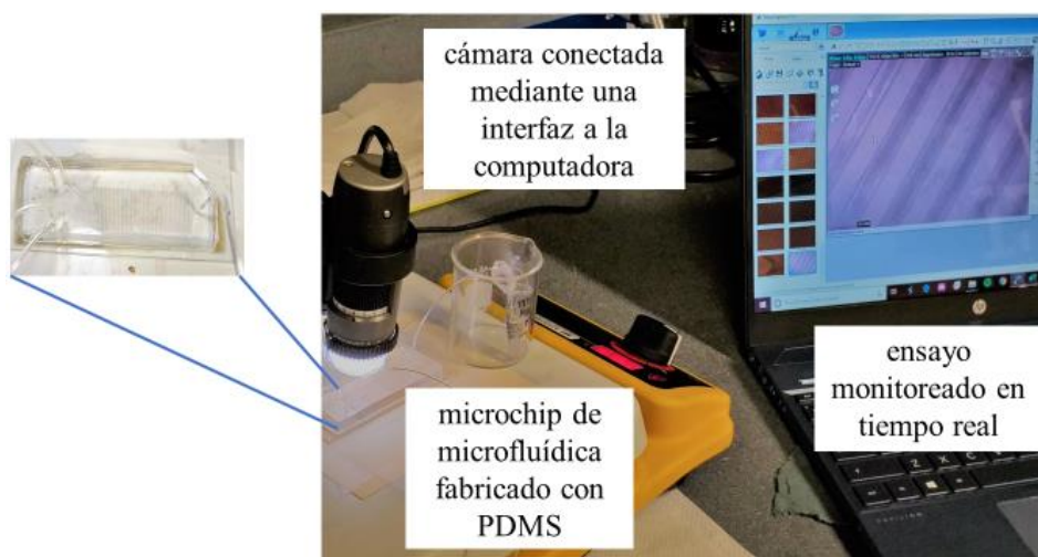
Figura 8. Microchip de microfluídica fabricado con polidimetilsiloxano (PDMS) monitoreado por una cámara digital Dino Lite y analizado con el software Dino Capture 2.0.
