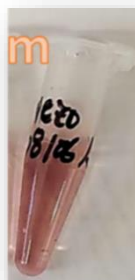
Figura 70. Dispersión coloidal de AuNPs sintetizadas con el microchip de microfluídica ( Dispositivo C1 ) usando el método de flujo continuo en una sola fase con cavitación , trabajando a 1000 \mu\text{L/h} con un tiempo de residencia de 15 min. Serpentín de PTFE a la salida del microchip sumergido en agua con calentamiento constante (90 ^{\circ}\text{C} ).
