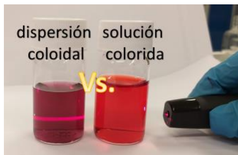
Figura 3. Comportamiento de la luz exhibido en una dispersión coloidal de nanopartículas de oro, mostrando el “efecto Tyndall” comparada con una disolución acuosa con colorante rojo que no presenta dicho fenómeno.
