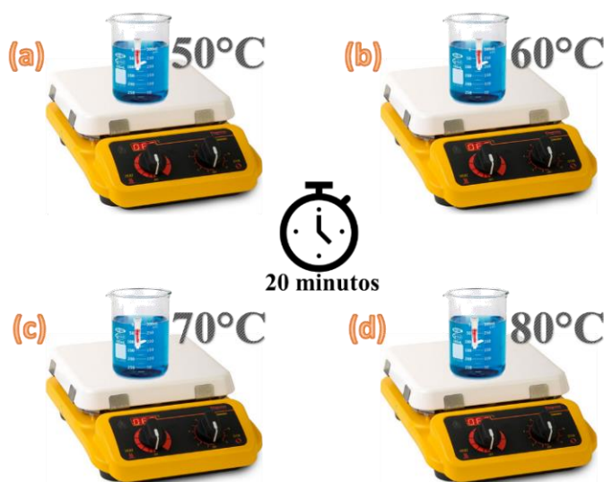
Figura 26. Representación esquemática de la prueba en miliescala (1.0 mL), mezclando 500 \mu L de una disolución precursora de oro 1.08 mM y 500 \mu L de una disolución reductora de citrato de sodio 3.4 mM ([citrato]/[Au]=3.15), dentro de tubos Eppendorf® de 1.5 mL. Los tubos (a), (b), (c) y (d), se calentaron a 50, 60, 70 y 80 °C, respectivamente.
