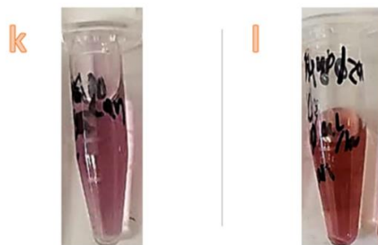
Figura 63. Dispersiones coloidales de AuNPs sintetizadas con el microchip de microfluídica ( Dispositivo B1 ) usando el método de flujo continuo con enfoque hidrodinámico para una sola fase , trabajando a dos diferentes flujos y tiempos de residencia: k ) 500 \mu\text{L/h} con un tiempo de residencia de 30 min, l ) 1000 \mu\text{L/h} con un tiempo de residencia de 15 min. Serpentin de PTFE a la salida del microchip sumergido en agua con calentamiento constante (90 °C).
