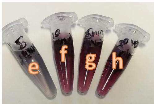
Figura 50. Dispersiones coloidales de nanopartículas de oro sintetizadas en miliescala a 4 diferentes tiempos: e) 5 min, f) 10 min, g) 15 min, h) 20 min. Sintetizadas a una misma temperatura de reacción (60 °C).
