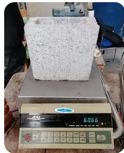
Figura 5.1 Piezas de mampostería y medición de pesos
