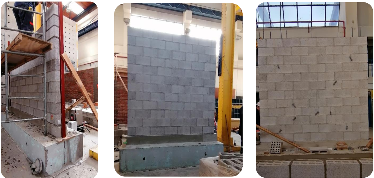
Figura 4.9 Espécimen MBRI-8, muro con refuerzo interior.
