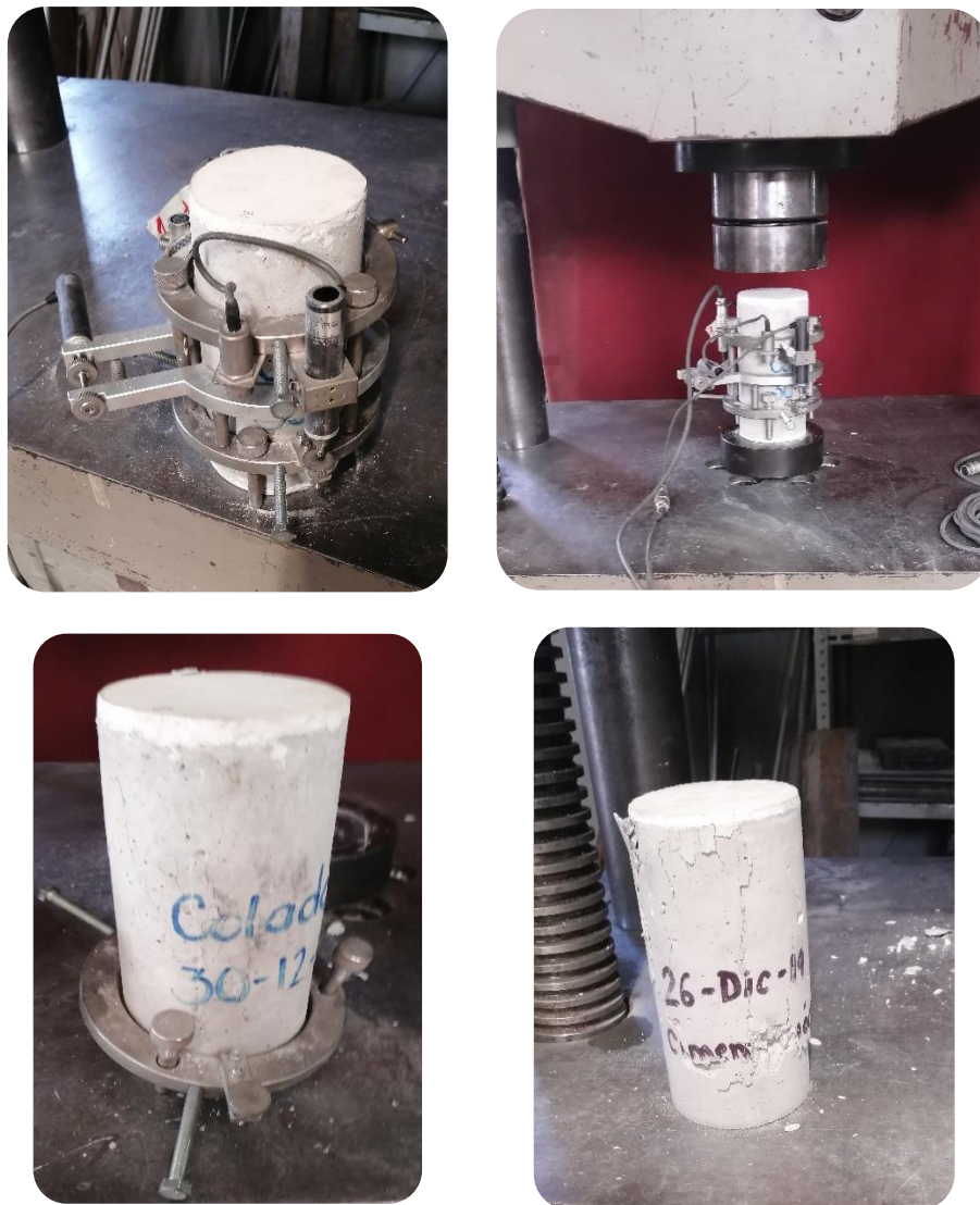
Figura A.7 Ensayo de cilindros de concreto
