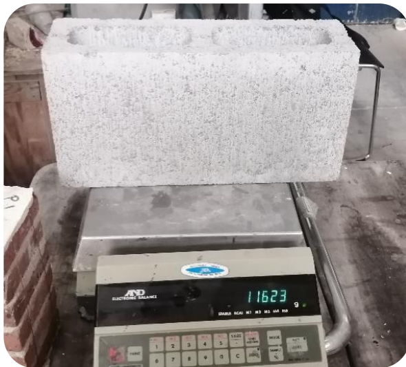
Figura 5.1 Piezas de mampostería y medición de pesos
