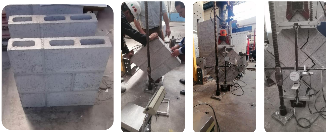
Figura A.4 Esquema y foto de la prueba de murete a compresión diagonal
