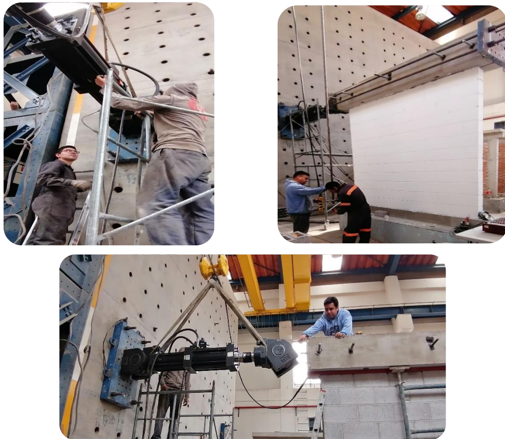
Figura 4.11 Montaje del actuador.
