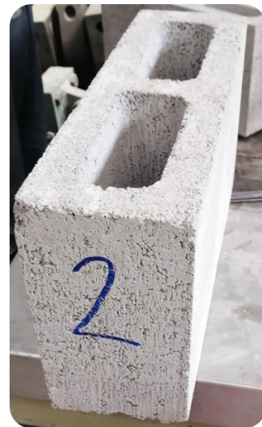
Figura 3.1 Piezas de concreto vibrocomprimido doble hueco
