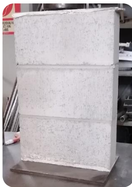
Figura 3.2 Probetas para ensaye a compresión y compresión diagonal de mampostería
