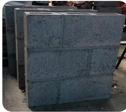
Figura 3.2 Probetas para ensaye a compresión y compresión diagonal de mampostería
