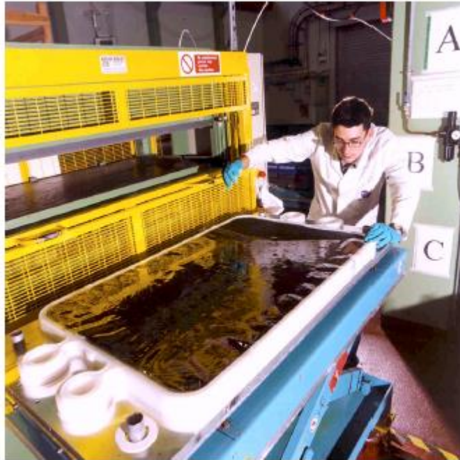
Figura 29. Ajuste de una membrana de intercambio iónico a una celda con marco de polímero soldada por calor [11] .
