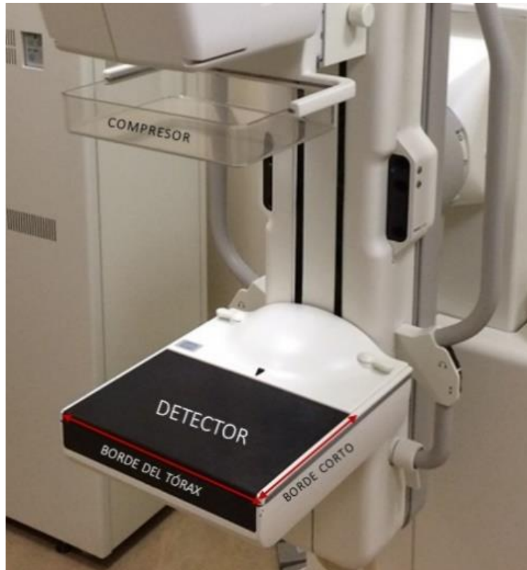
Figura 19: Detector del Senographe 2000D
