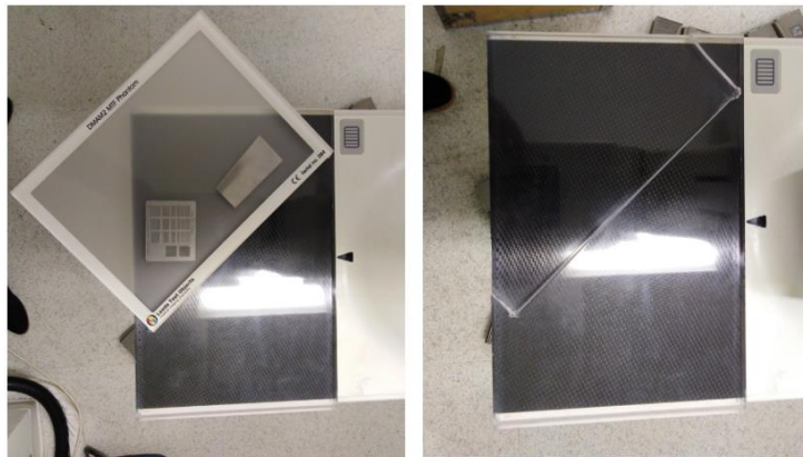
Figura 44: Placas de PMMA para colocación de la placa MTF.
