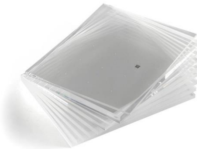
Figura 21: Placas de PMMA del DMAM2, la placa superior, tiene una placa de aluminio incrustado para realizar algunas pruebas.
