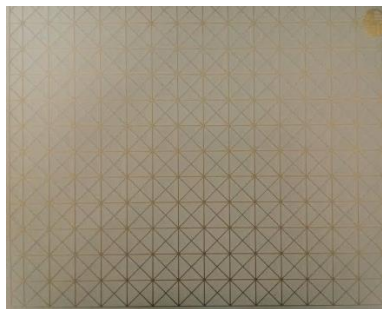
Figura 23: Malla radiopaca del DMAM2 para la prueba de distorsión geométrica.
