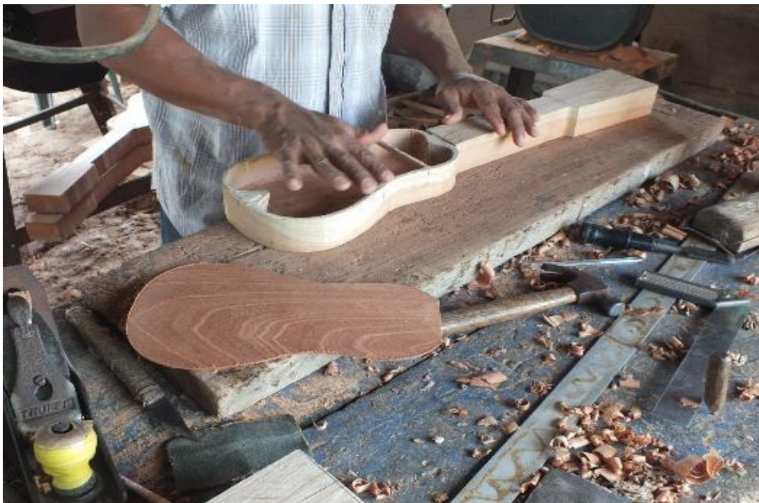
Imagen 52. En la imagen se pueden apreciar varias partes que conforman una jarana: Caja de resonancia, brazo y cabeza donde van las cuerdas, y la tapa. Foto: José Andrés García Méndez, diciembre 2012.
