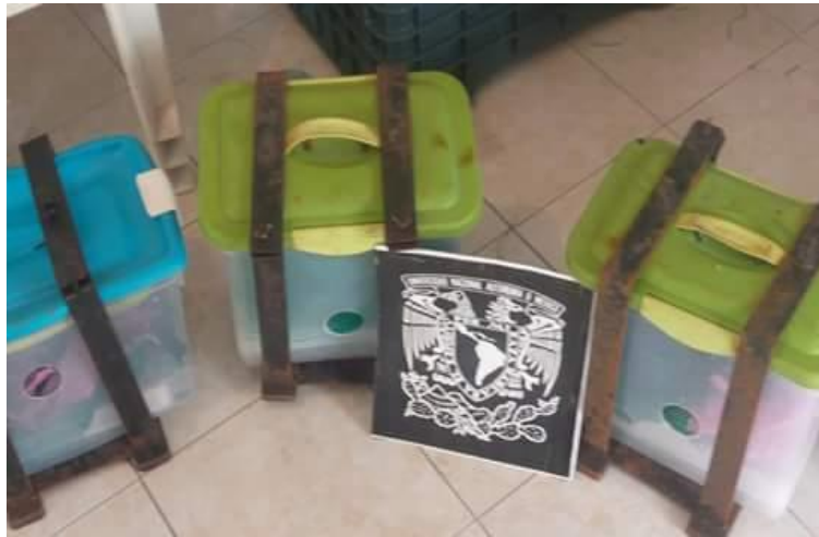
Figura 2. Trampas de luz. Las trampas se elaboraron adaptando cajas plásticas cuyas dimensiones son de 40 cm de largo, 25 cm de ancho y 30 cm de altura
