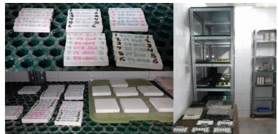
Ilustración 34 imagen obtenida con fines didácticos; muestras de pastas en proceso de curado a una humedad relativa \geq 95\% y una temperatura de 21° C, con un rango de \pm 2^\circ C. (Instituto de ciencias de la construcción Eduardo Torroja, CSIC).
