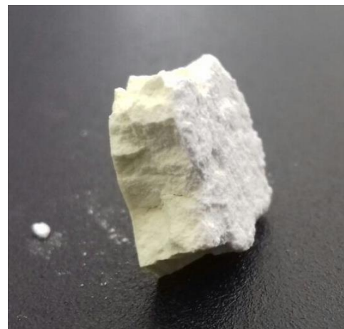
Ilustración 71 Capturada con fines didácticos, la muestra expuesta en esta prueba de calorimetría presenta segregación, la parte inferior es de color amarillo y muestra fotoluminiscencia, la parte superior de color blanco carece de dicha propiedad
