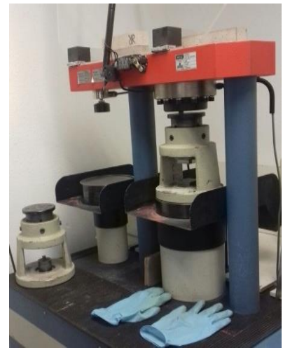
Ilustración 37 imagen obtenida con fines didácticos; prensa empleada para la rotura de las probetas de pasta a compresión. (Instituto de ciencias de la construcción Eduardo Torroja, CSIC)
