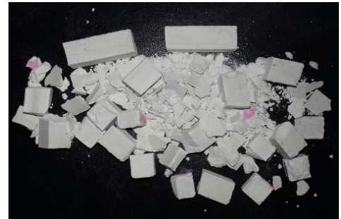
Ilustración 35 imagen obtenida con fines didácticos; muestras de pastas sometidas en ensayo destructivo a flexotracción y compresión. (Instituto de ciencias de la construcción Eduardo Torroja, CSIC).
