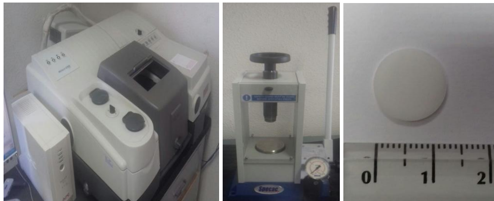
Ilustración 25 - Imagen capturada con fines didácticos; Espectrómetro ATI MATTSON GENESIS, Prensa de 10 toneladas y pastilla obtenida mediante Cem BL I 52.5 R y bromuro de potasio (KBr) para análisis por FTIR. (Instituto de ciencias de la construcción Eduardo Torroja, CSIC)
