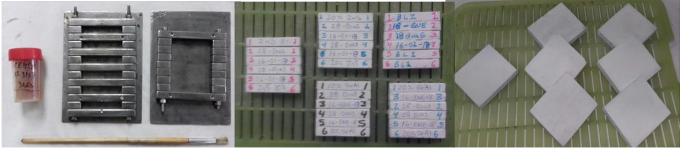
Ilustración 33 imagen obtenida con fines didácticos; moldes para la elaboración de probetas de pastas para pruebas mecánicas y de luminiscencia, a dichos moldes se les aplico una capa de desmoldante, para pruebas de flexión y compresión 6.0x1.0x1.0 cm. Y para pruebas de luminiscencia 6.0x7.0x1.0 cm.
