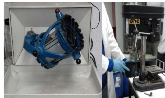
Ilustración 31 Imagen obtenida con fines didácticos; turbula utilizada para homogenizar las mezclas anhidra, y Mezcladora utilizada para las pastas hidratadas, todas las proporciones estuvieron por 3:00 minutos para garantizar una mezcla hidratada homogénea. (Instituto de ciencias de la construcción Eduardo Torroja, CSIC).
