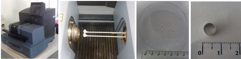
Ilustración 26 - Imágenes capturadas con fines didácticos; Equipo utilizado para el Análisis Térmico Diferencial (ATD) y Termogravimétrico (TG) TA SDT Q 600. 30 mg de pigmento fotoluminiscente utilizados para el Análisis, se utilizó un contenedor de platino. (Instituto de ciencias de la construcción Eduardo Torroja, CSIC).
