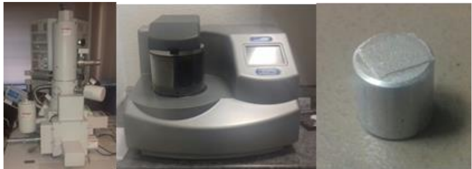
Ilustración 28 Imagen capturada con fines didácticos. Microscopio JEOL 5400, acoplado a un espectrómetro de dispersión de energía de rayos X de la marca OXFORD LINK-ISIS-EDX, Evaporador de carbono a alto vacío Cressington 208 CarbonTurbo, Las muestras secadas al vacío y metalizadas con carbón. (Instituto de ciencias de la construcción Eduardo Torroja, CSIC).
