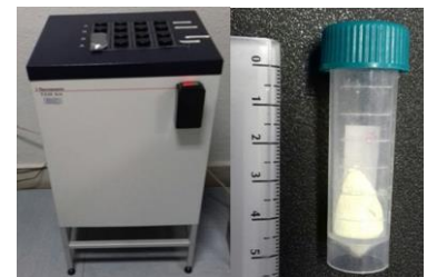
Ilustración 27 Imagen capturada con fines didácticos. Calorímetro y 5 g de muestra para prueba de calorimetría, Marca Thermometric; Mod. TAM AIR. (Instituto de ciencias de la construcción Eduardo Torroja, CSIC)
