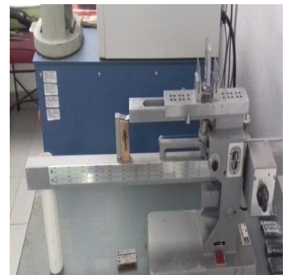
Ilustración 36 imagen obtenida con fines didácticos; equipo Nietzsche para rotura a Flexotracción de las probetas de pasta. (Instituto de ciencias de la construcción Eduardo Torroja, CSIC).
