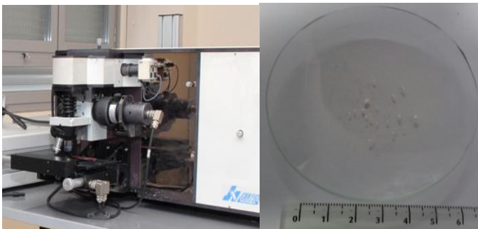
Ilustración 29 – imagen extraída con fines didácticos. Espectrómetro FT-Raman (Bruker RFS/100) con microscopio acoplado que permite trabajar en bancada (geometrías de 90 y 180°) o en el microscopio (180°). Y 50 mg de pig YG-1300 para Espectroscopia Raman
