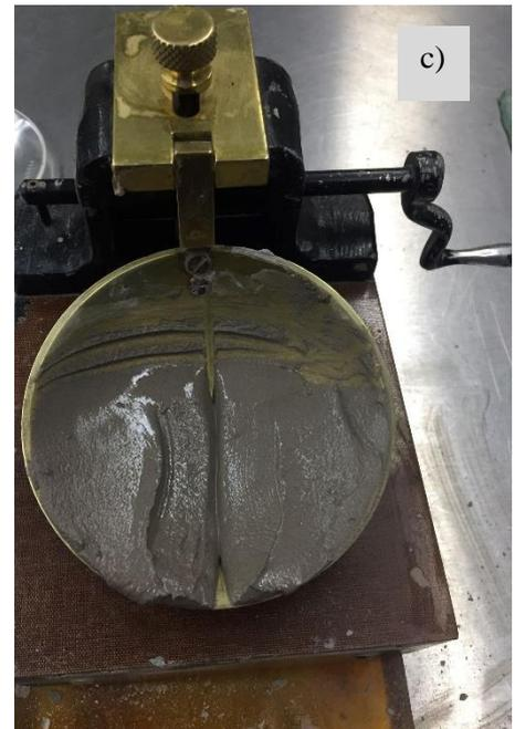
Fig. 2.18 Procesos para la obtención de PL y LL. a) Copa Casagrande y material para LL b) Muestras en horno de PL y LL c) Material unido tras la abertura en el centro
