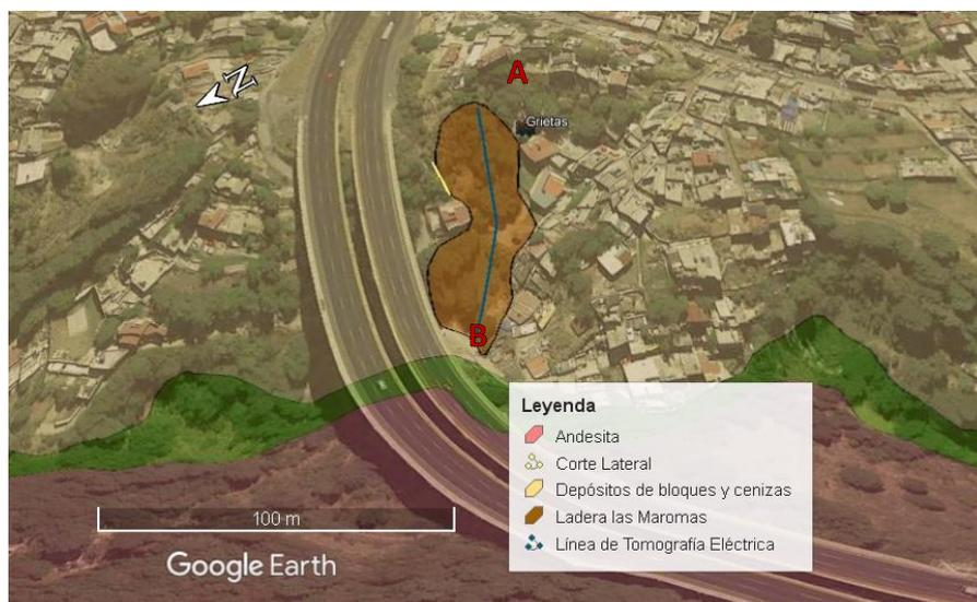
Fig. 5.2 Ubicación de la ladera Las Maromas, en la imagen se muestra su entorno tanto geológico, así como la interacción con aspectos antrópicos. Se muestra la sección A-B realizada con la tomografía eléctrica.
