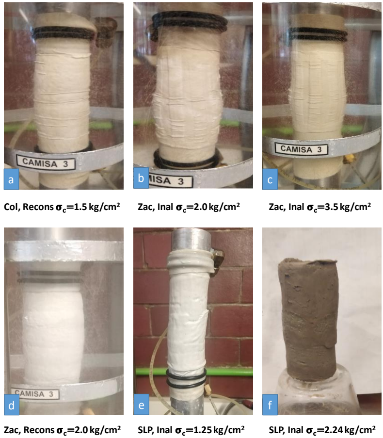
Figura 5-23 Probetas previo a culminar la etapa de falla o ya falladas.
