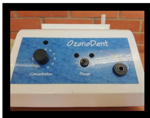
(Figura 11) Generador de Ozono 36
