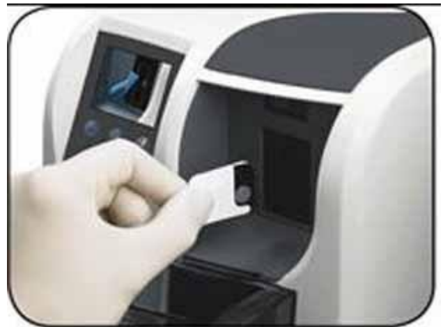
Figura 20 Maquina para el procesado de una placa de fósforo.
