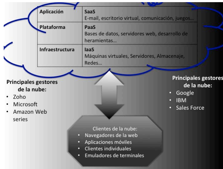
Fig. 1.14 Esquema de la nube, con los servicios que actualmente engloba y los principales consorcios que la impulsan, donde las siglas significan: SaaS (Software as a Service); PaaS (Platforms as a Service), e IaaS (Infrastructure as a Service) . Fuentes: elaboración propia a partir de Hamdaqa, 2012, google reports y Wikipedia (07/01/17).
