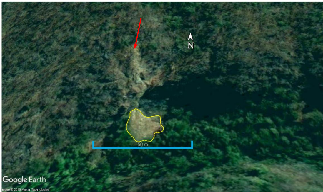
Figura 4.15. Caída de detritos. Se observa la cicatriz del desprendimiento (indicada con flecha roja) y el depósito de detritos (color amarillo) (coordenadas: 2,020,958.02 m N, 712,762.46 m E). Fecha de fotografía: 30 de mayo de 2009.
