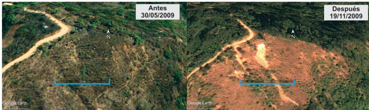
Figura 4.17. Deslizamiento rotacional. Se alcanza a apreciar la diferencia entre la imagen de antes y después. En la imagen de después, se aprecia menos vegetación en comparación con la imagen de antes del movimiento en masa. Coordenadas: 709,918 m E; 2,023,467.13 m N.
