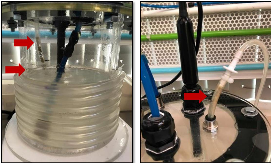
**Figura 11.** Adhesión y acumulación de la biomasa en el reactor durante el proceso OXANME. Las flechas indican los puntos de acumulación de biomasa más importantes.
