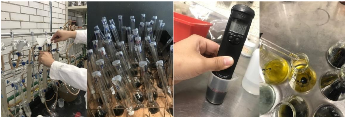
Figura 15. Parámetros químicos del suelo determinados en laboratorio. De izquierda a derecha: Nitrógeno total, Fósforo extraíble, pH y Contenido de materia orgánica.
