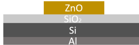
Figura 19. Esquema general del transistor después de aplicar la fotomáscara 0.
