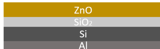
Figura 17. Estructura general del dispositivo \psi - MOSFET antes de pasar por las etapas de fotolitografía.
