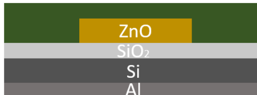
Figura 20. Esquema general del transistor después de aplicar la capa de parileno.
