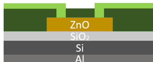
Figura 24. Esquema final propuesto para el transistor \psi -MOSFET.
