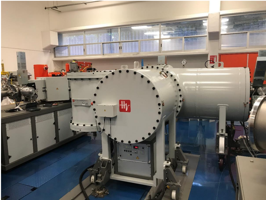
Figura 2. 7: Fotografía del tanque del acelerador tipo tándem de 1 MV
