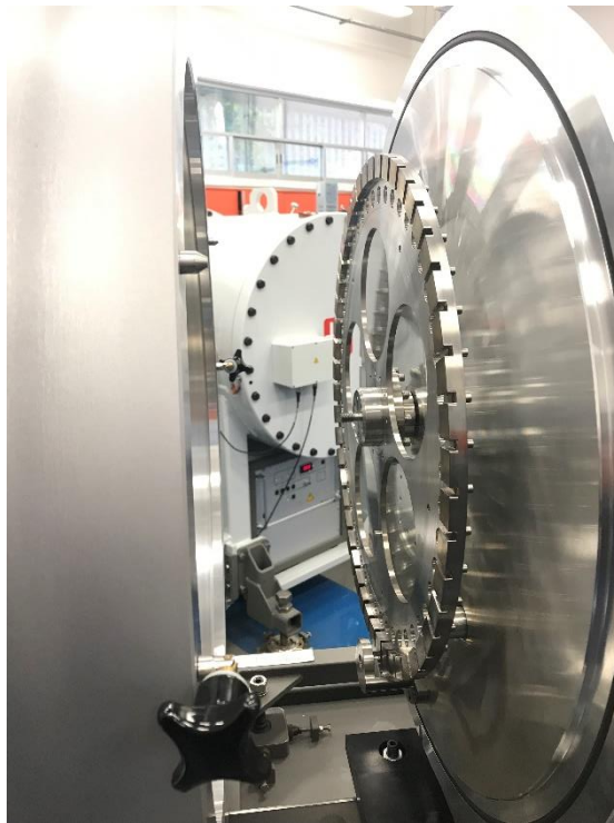
Figura 2. 4: Imagen del interior del carrusel de 50 posiciones donde se montan los cátodos que se van a introducir en la fuente de iones tipo SNICS.
