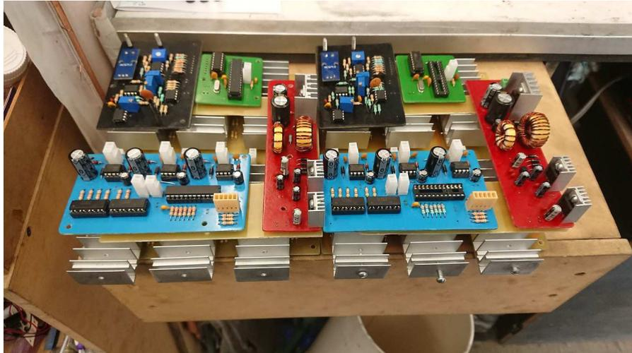
Figura 7.5: Nueva versión del controlador para motores brushless de 3 fases.
