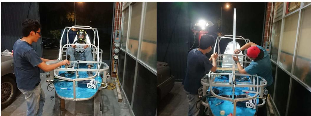
Figura 3.63: Colocación del tablero, volante y pedal de freno.
