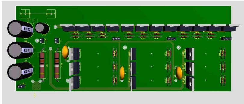
Figura 5.2: Diseño de la etapa de potencia para el vehículo prototipo VF.
