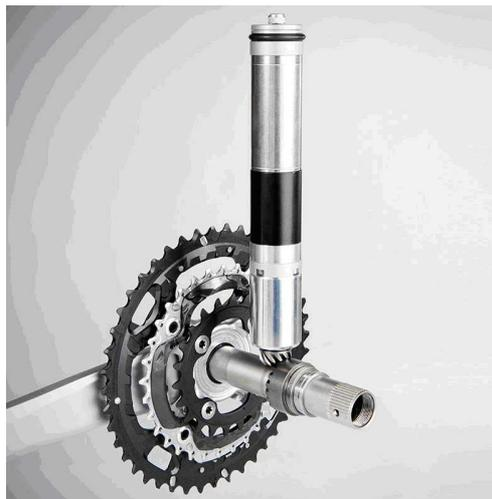
Figura 1.18: Vivax Assist acoplado al eje de los pedales [R18].
