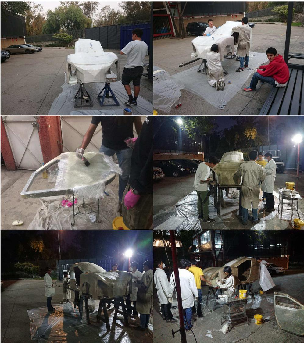
Figura 3.47: Colocación de la fibra de vidrio sobre el molde del vehículo Urbano.
