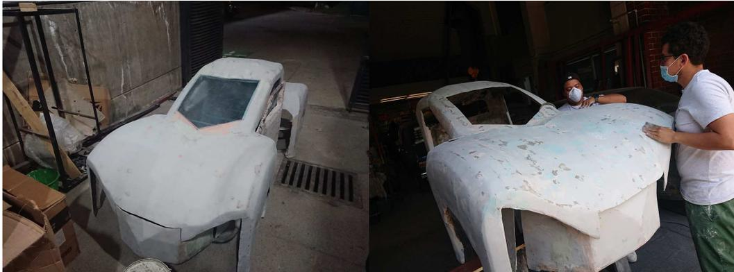
Figura 3.56: Segundo detallado y rellenado de huecos de la carrocería del vehículo Urbano.
