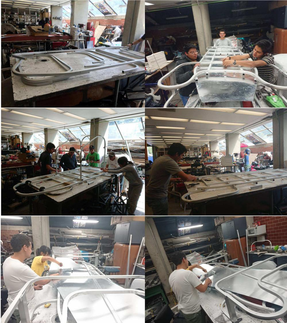
Figura 3.53: Armado del chasis del Urbano, empleando tubos de aluminio rolados.
