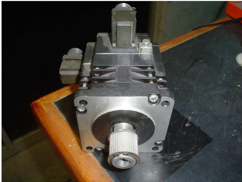
Figura 4.6: Motor encontrado en la máquina CNC EMCO LS140 [1].
