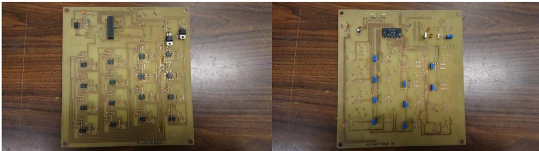
Figura 4.29: BMS V1 construido para la formula Shell 2013.
