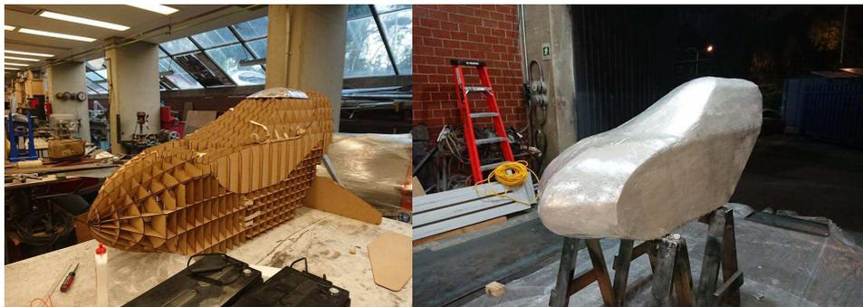
(a) Moldes para la carrocería del prototipo armada.
