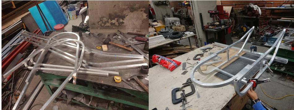
Figura 7.2: Manufactura del chasis final.
