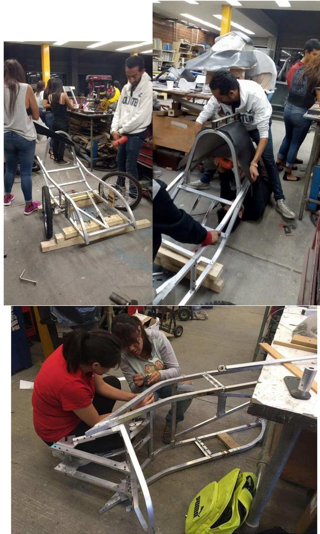
Figura 3.31: Ensamble del segundo chasis.
