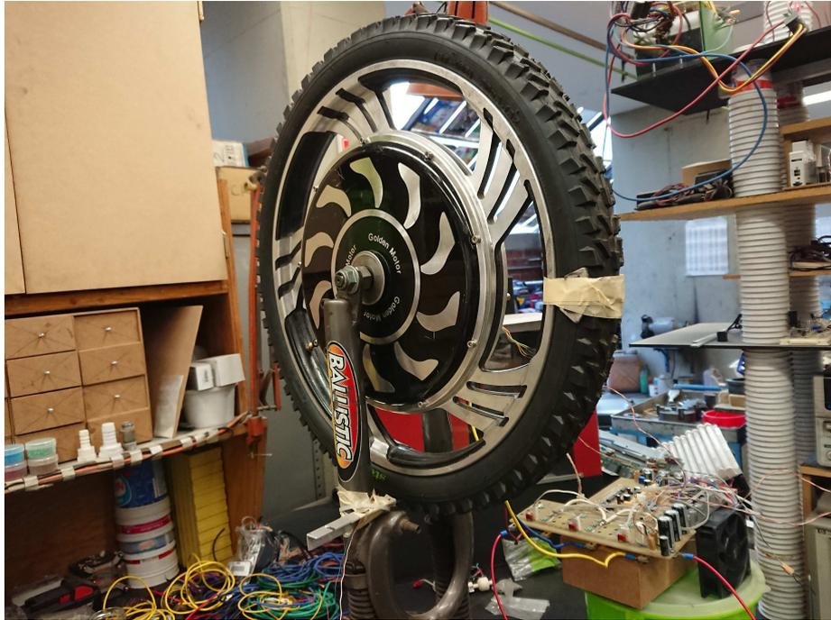
Figura 4.23: Motor brushless de 3 fases a 1000 [W].
