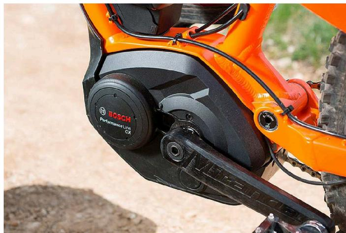
Figura 1.2: Sistema de asistencia de pedaleo Bosch Performance Line.
