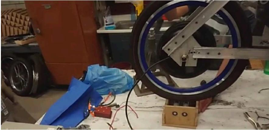
Figura 5.11: Sistema de pruebas para controladores.
