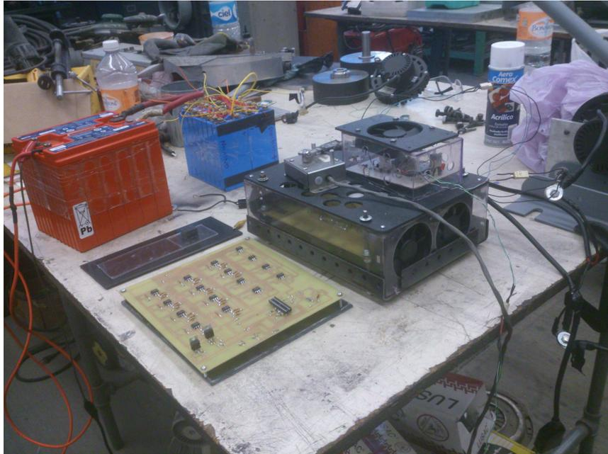
Figura 4.19: Controlador V5 para motor de 8 [HP].
