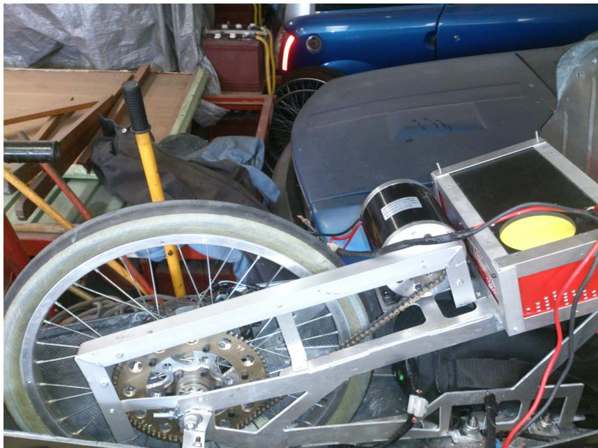
Figura 4.21: Controlador V6 colocado junto al motor de 1 [HP].
