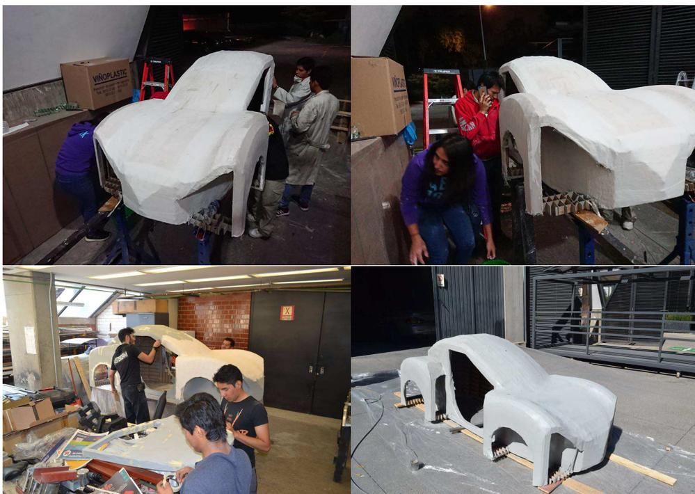
Figura 3.46: Preparación del molde del vehículo Urbano para colocar fibra de vidrio.
