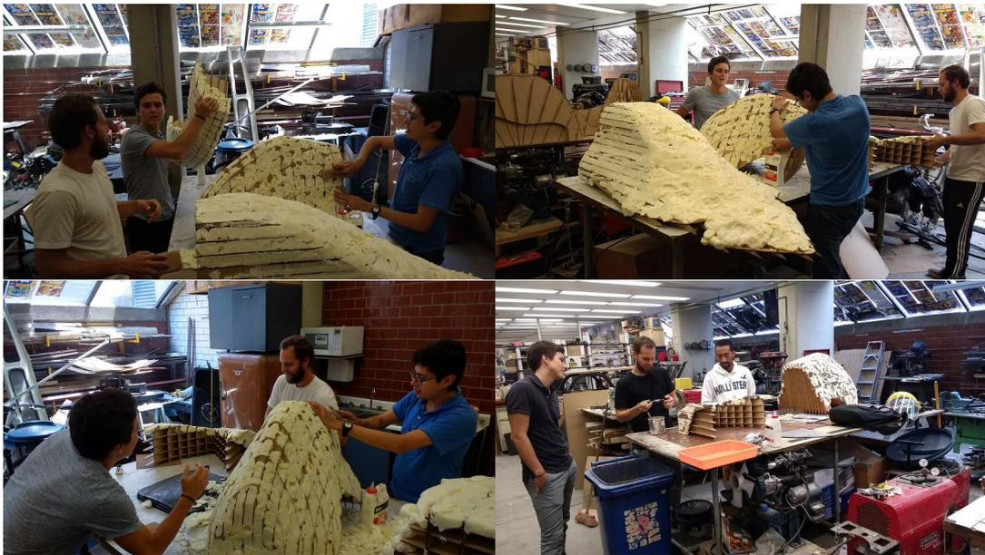
Figura 3.12: Moldes llenos de espuma y lijado de los mismos.
