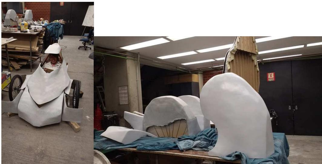
Figura 3.23: Colocación de la base en la carrocería.
