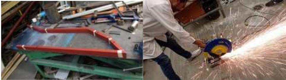
(a) Manufactura del chasis de prueba.
