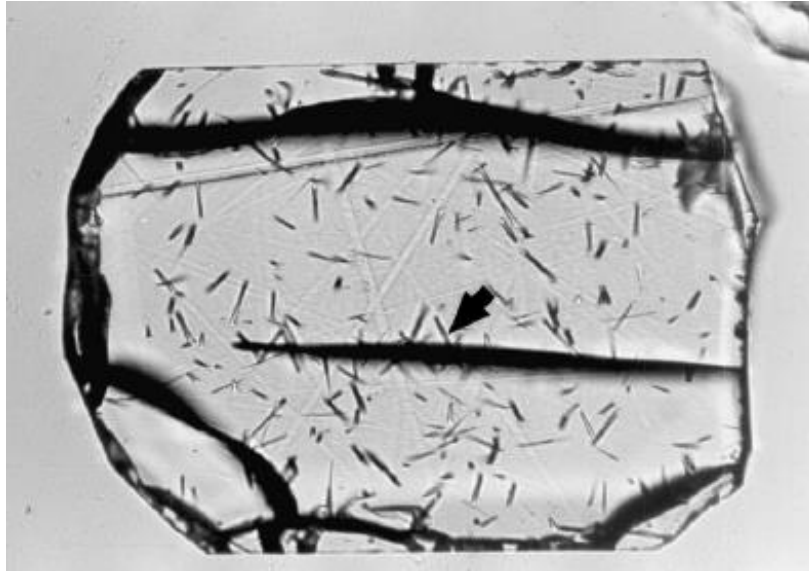
Figura 15. Trazas de fisión reveladas mediante el ataque químico en un cristal de apatito. La flecha indica una traza de fisión confinada dentro del cristal. Tomado de Gallagher et al. 1998.
