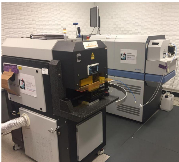
Figura 27. Espectrómetro de masas acoplado a ablación láser de la Universidad de Arizona. En la izquierda se observa el láser Photon Machines Analyte G2 excimer equipado con una celda de ablación HelEx . En la derecha se observa el espectrómetro de masas Element2 HR . La línea de color azul que conecta a ambos equipos contiene el helio que se encarga de transportar el material ablatado del láser al espectrómetro de masas para su medición isotópica.
