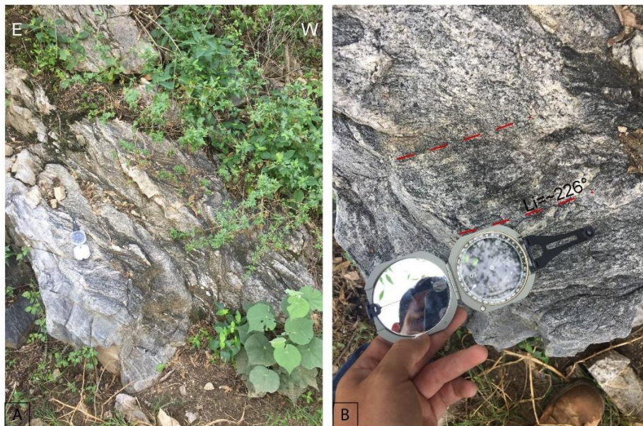
Figura 34. Aspecto de la deformación de la falla Puerta del Sol en la localidad del rancho El Tepuchi. A: planos de foliación desarrollados en las rocas intrusivas de la Sierra El Jaralito. B: dirección de la lineación de estiramiento.
