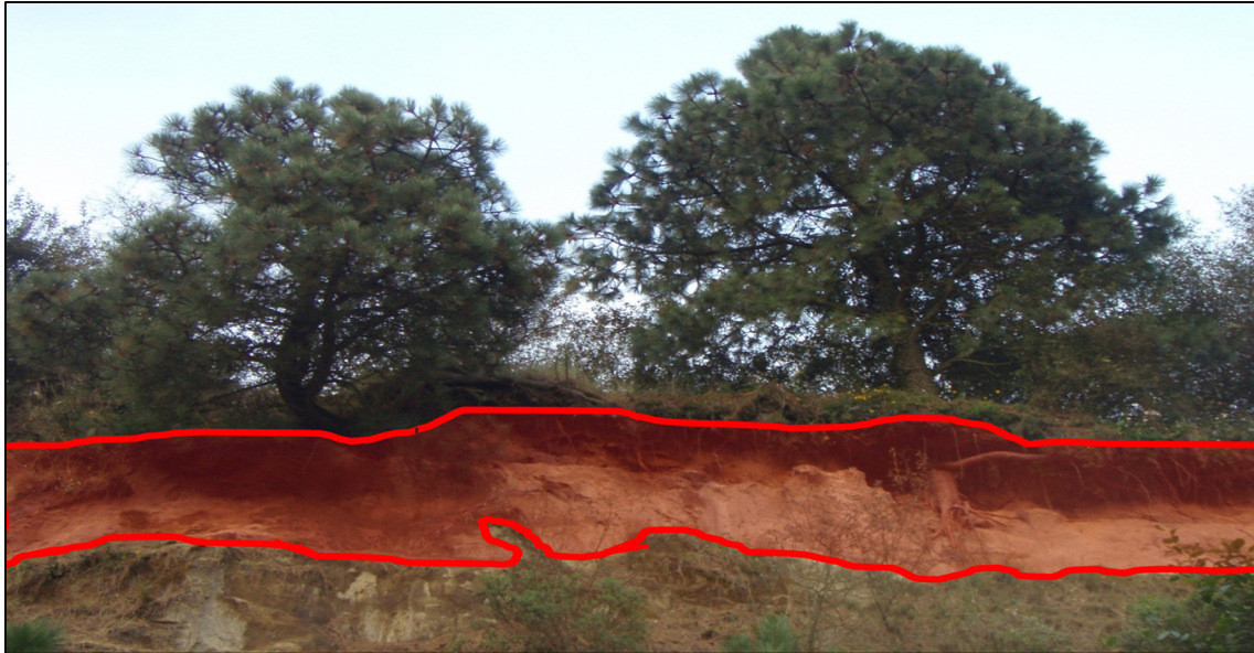
Figura 54. DAP en el que se aprecia que el plano de deslizamiento con una altura de 9 metros está por debajo de las raíces de los árboles. Elaboración propia con información de campo.
