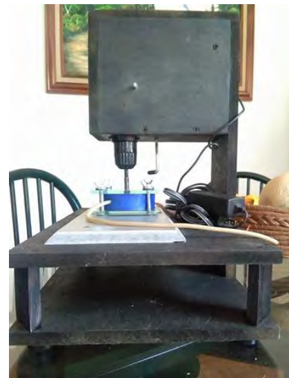
FIG IV.14 Vista lateral de la bomba peristáltica
