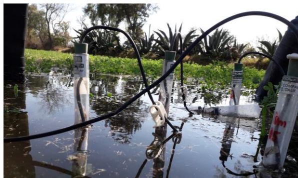
Fig. 6 Instalación de lisímetros con los que se obtuvieron las muestras de agua intersticial.
