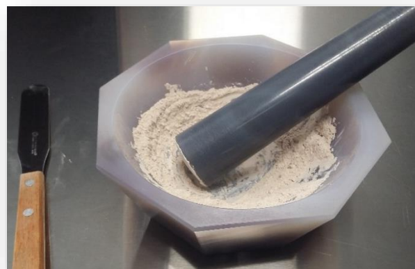
Figura 10. Preparación de las muestras en el mortero de ágata para sus posteriores análisis mineralógicos y de geoquímicos.
