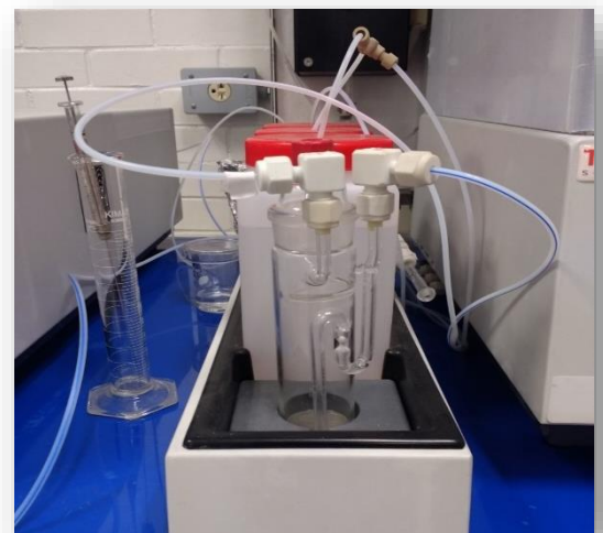
Figura 16. Sistema de análisis para medición de carbono inorgánico en el equipo de HiPerTOC.
