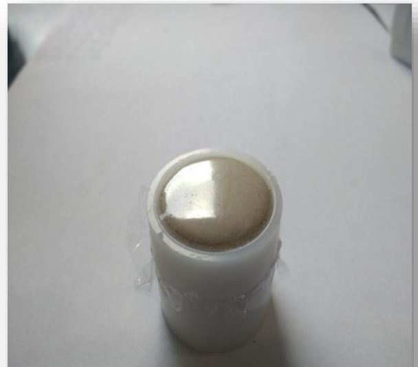
Figura 13. Fotografía de una muestra molida y seca en una cápsula de plástico para su análisis por FRX.
