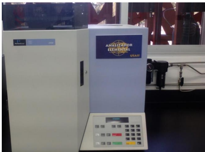
Figura 18. Analizador elemental CHS/O 2400 Serie II Perkin Elmer empleado para el analisis de Nitrógeno en la Cuenca del paleolago Sandia (Duarte, 2017).
