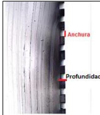
**Figura 42.** Fotografía del corte transversal de los microcanales del microchip para la extracción con etanol o metanol.
