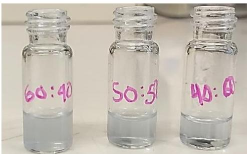
**Figura 49.** Resultado cualitativo para la evaluación del porcentaje metanol:agua en la extracción-reacción de la fracción fenólica del aceite de oliva en el microdispositivo.
