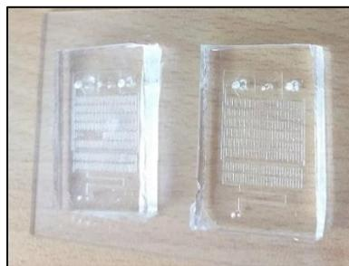
**Figura 44.** Micordispositivos de PDMS pegados en portaobjetos para la extracción con solución amortiguadora de carbonatos.
