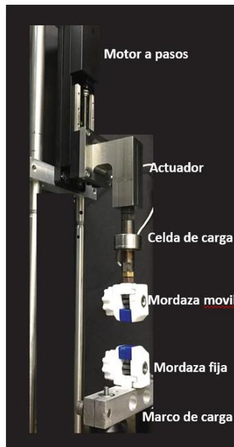
Figura 9. Probador de tracción uniaxial, Laboratorio de mecánica y micro-mecánica de sólidos-IIM, UNAM.
