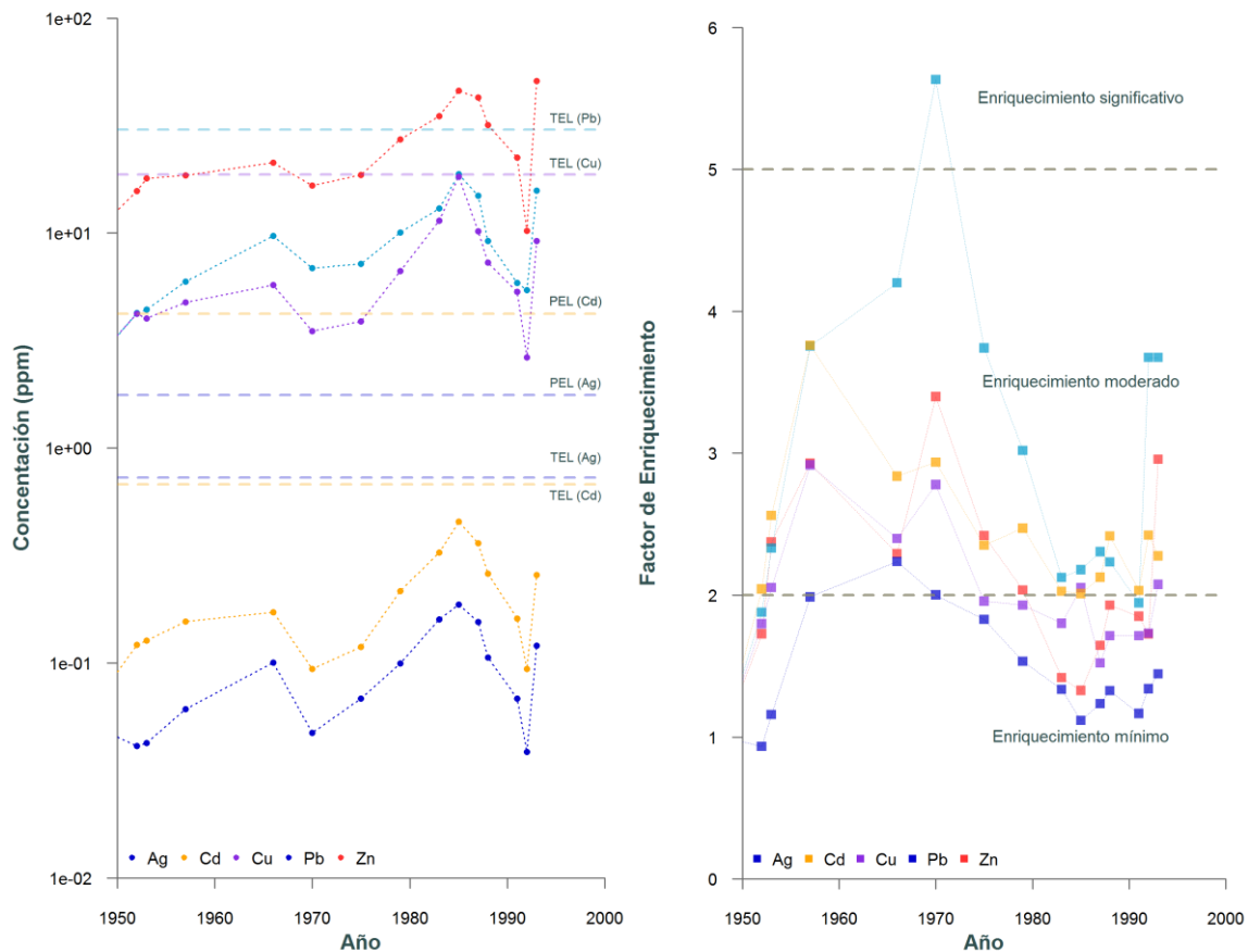
Figura 28. a) Concentraciones de los EPT's e índices TEL y PEL. Las unidades están en escala logarítmica con valores de concentración de 0.01 a 100. Las líneas punteadas de colores representan los valores de referencia para TEL y PEL de cada EPT. b) Factor de enriquecimiento de los EPT's.
