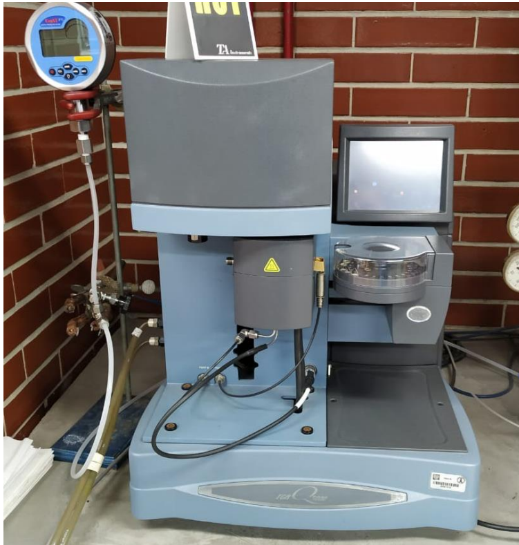
Fig. 15. Equipo TGAQ5000, del Laboratorio de Análisis Térmico del IIM, UNAM.
