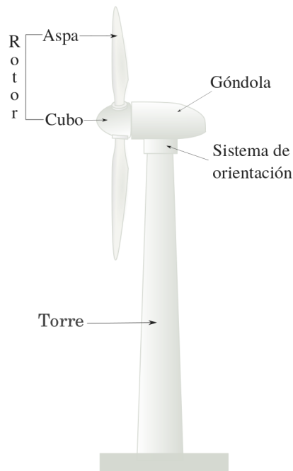
Figura 2.4: Componentes principales de un aerogenerador HAWT. Imagen tomada y editada de: Nordman .
