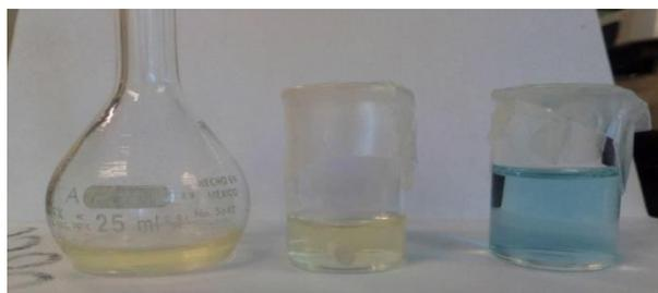
**Figura 10-4.** Disolución  $1 \times 10^{-3} \text{ mol L}^{-1}$  de ferroceno en acetonitrilo (izq.), disolución  $1 \times 10^{-3} \text{ mol L}^{-1}$  de ferroceno en acetonitrilo con la membrana (centro) y disolución donde se mantuvo la membrana del electrodo de referencia durante 5 días (der.). El color azul indica que toda la plata difundió de la membrana.
