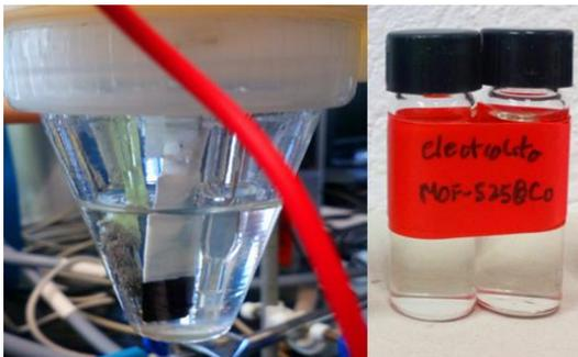
**Figura 7-24.** Fotografía tomada a la celda electroquímica durante los experimentos con el SURMOF-525@Co-PC (izq.) y electrólito (der.) al término de estos.
