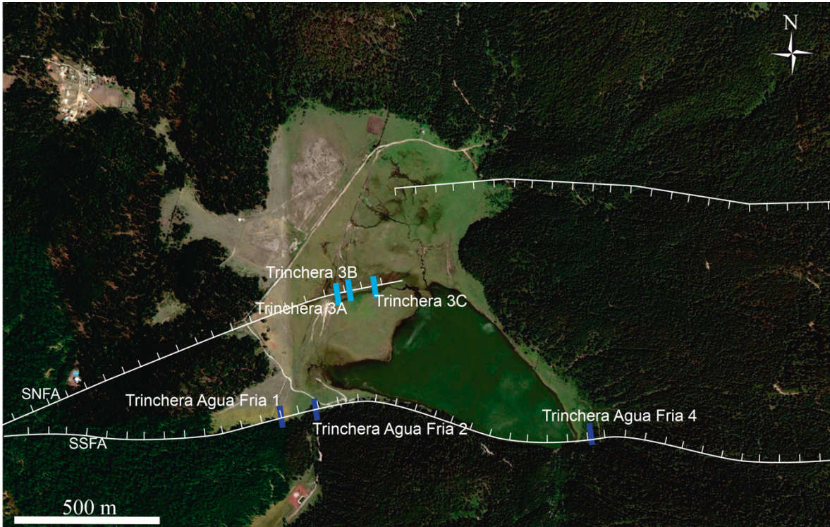
Figura 18: Fotografía Aérea de la cuenca de Llano Grande con la ubicación de las 6 trincheras de paleosismología. Las trincheras 1,2,4 (indicadas en tono azul marino), corresponden a las trincheras analizadas en este trabajo. Las trincheras en azul claro representan las analizadas por Campos-Medina (2019). SNFA: Segmento Norte de la Falla Agua Fría. SSFA: Segmento Sur de la Falla Agua Fría.
